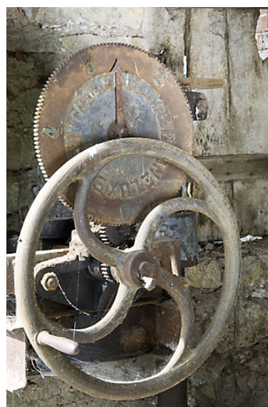
Atelier de scierie. Volant du mécanisme d'admission d'eau de la turbine. Phot. Jérôme Mongreville IVR43_20077000150NUCA
