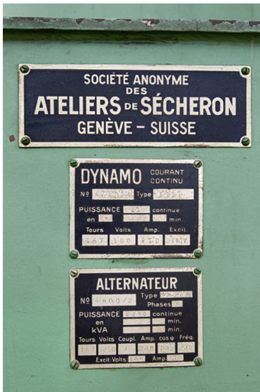
Plaque de constructeur de l'alternateur.
