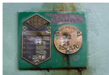
Réservoir d'air comprimé. Plaque d'épreuve. Phot. Yves Sancey IVR43_20122501945NUC2A
