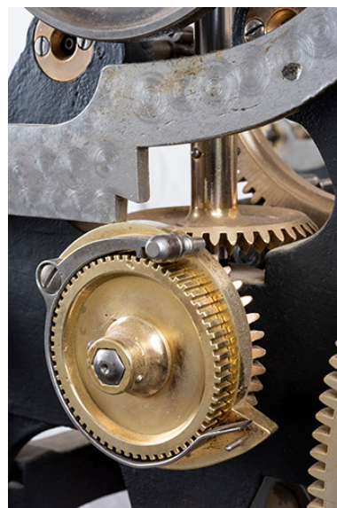
Mouvement, mécanisme des heures : roue dentée et pignons de renvoi. Phot. Sonia Dourlot IVR43_20182501653NUC4A
