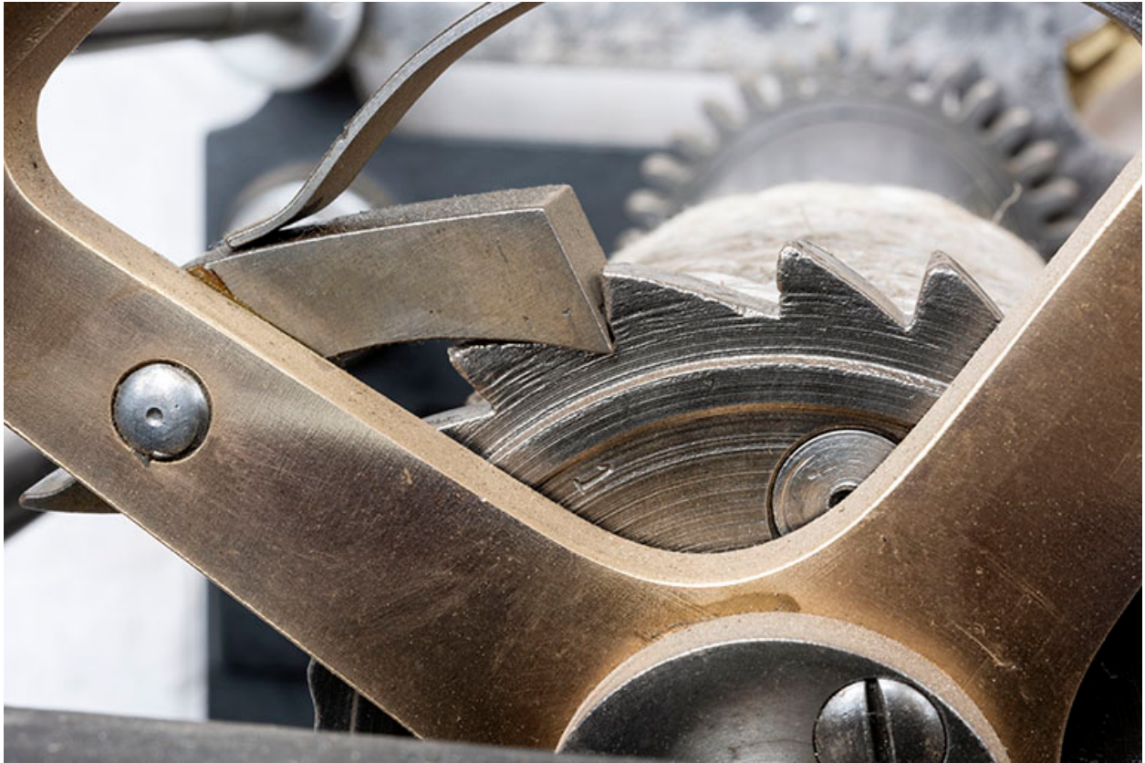
Mouvement, mécanisme des sonneries : détail du cliquet.
