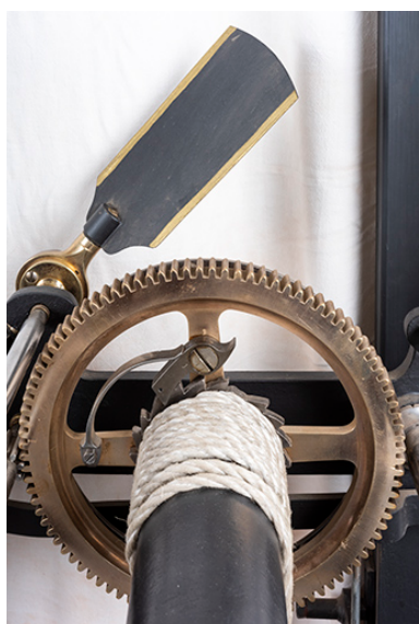
Mouvement, mécanisme des sonneries : tambour et son cliquet (à gauche, l'hélice-frein).
