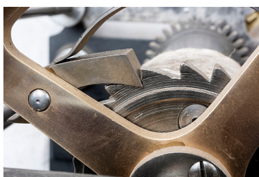
Mouvement, mécanisme des sonneries : détail du cliquet.
