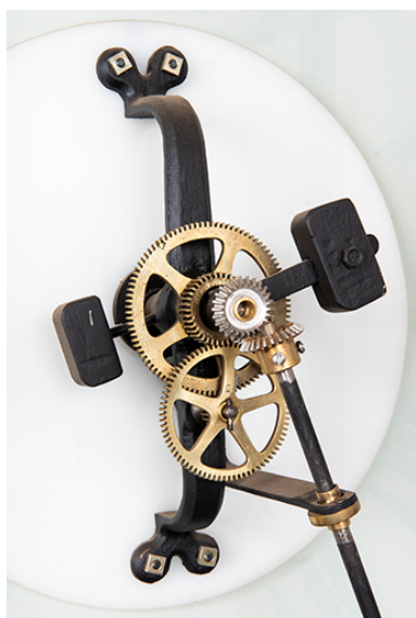
Cadran : système de renvoi et commande des aiguilles (au verso).
