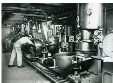
Atelier de fabrication des bonbons. Cuiseurs sous vide, s.d. [vers 1960]. IVR43_20192500083NUC4A
