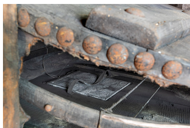
Forge : intérieur du soufflet en cuir montrant un clapet. Phot. Sonia Dourlot IVR43_20192501347NUC4A
