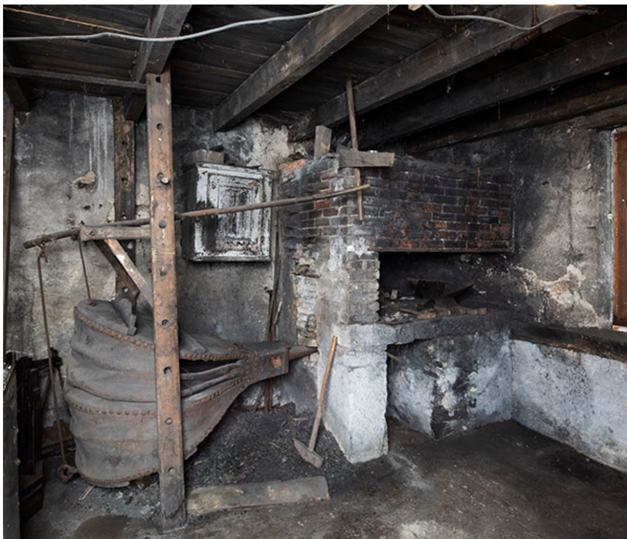
Forge : soufflet, foyer et établi (à droite).
