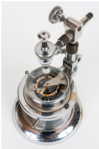
Vue plongeante montrant la boîte contenant le balancier-spiral étalon. Phot. Sonia Dourlot IVR43_20162501345NUC4A
