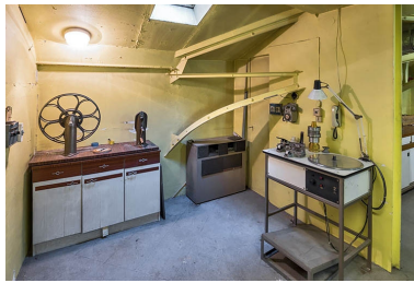
Installation de rembobinage manuel à gauche et table de bobinage Kinoton ST-272 à droite. Phot. Pierre-Marie Barbe-Richaud IVR26_20212100313NUC4A
