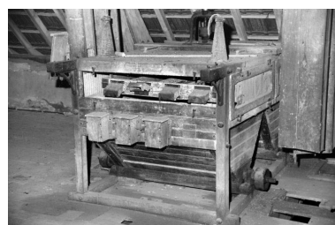
Minoterie, étage de comble : trieur à grains Lacroix. Phot. Laurent Poupard IVR43_19883900649Z
