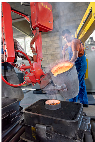
Coulée dans un grand châssis. Phot. Sonia Dourlot IVR43_20182501059NUC4A
