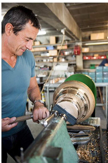
Tournage d'une cloche : geste de l'ouvrier. Phot. Sonia Dourlot IVR43_20182501090NUC4A
