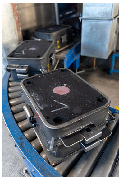
Refroidissement du bronze dans des grands châssis. Phot. Sonia Dourlot IVR43_20182501069NUC4A
