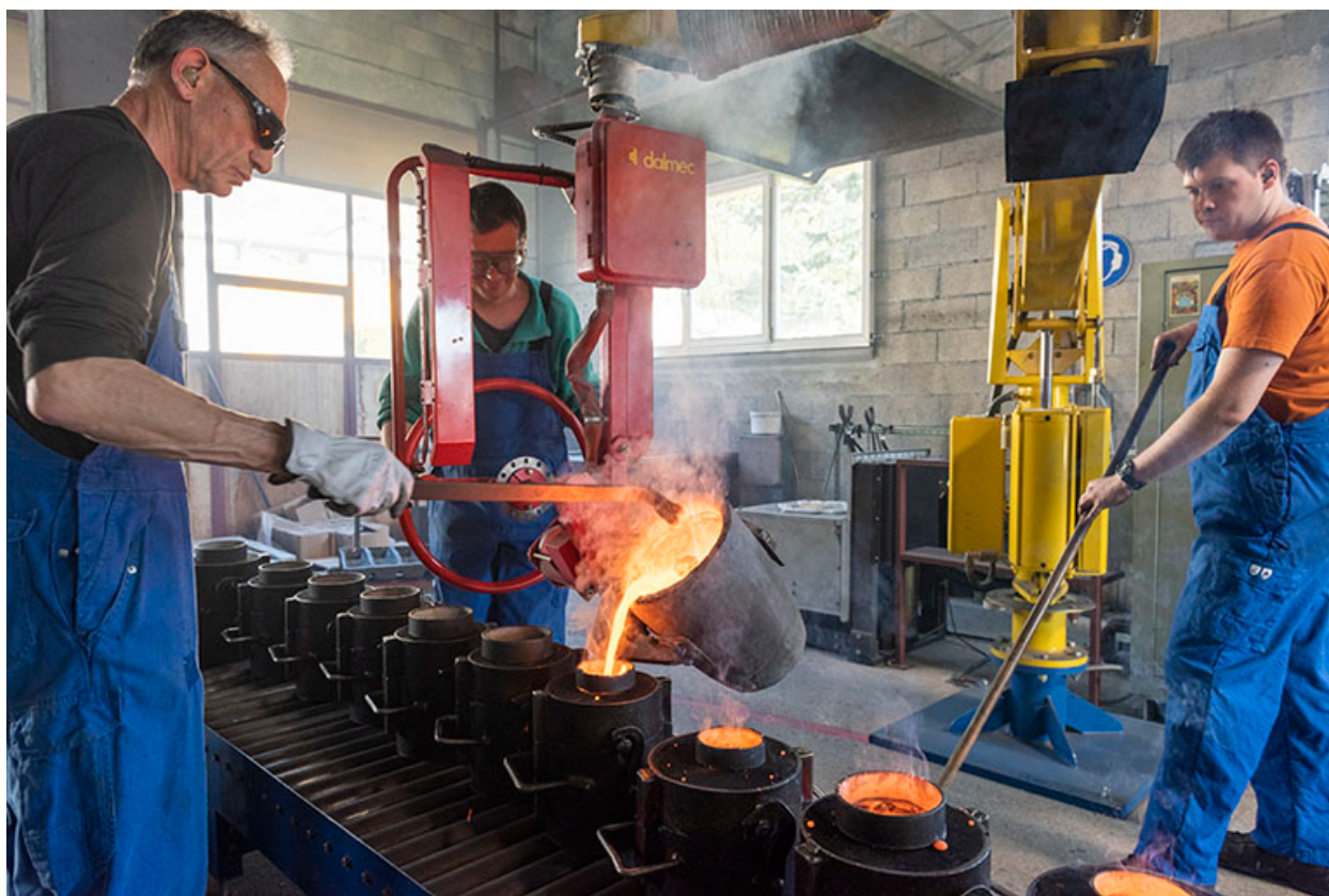
Coulée dans un petit châssis (Yves Obertino éloigne les scories avec une barre métallique).
