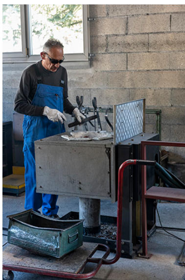
Yves Obertino surveillant la fonte du bronze dans le four électrique. Phot. Sonia Dourlot IVR43_20182501055NUC4A
