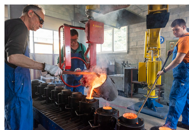
Coulée dans un petit châssis (Yves Obertino éloigne les scories avec une barre métallique). Phot. Sonia Dourlot IVR43_20182501063NUC4A
