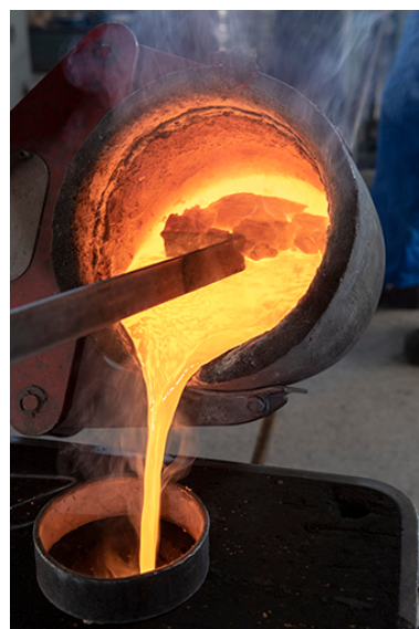
Coulée dans un grand châssis : les scories sont éloignées à l'aide d'une barre métallique. Phot. Sonia Dourlot IVR43_20182501065NUC4A
