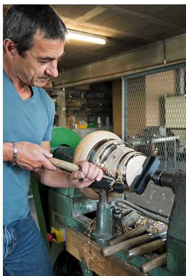
Tournage d'une cloche : geste de l'ouvrier. Phot. Sonia Dourlot IVR43_20182501093NUC4A
