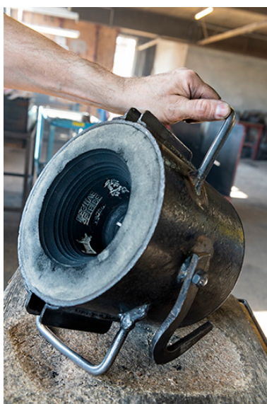
Fabrication du moule : moule en creux avec ses inscriptions et ses décors. Phot. Sonia Dourlot IVR43_20182501082NUC4A
