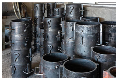
Fabrication du moule : les châssis.
