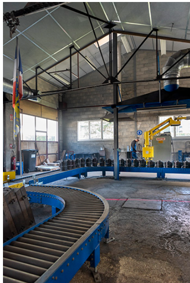
Intérieur de l'atelier au rez-de-chaussée : convoyeur avec, au fond, la zone de coulée.
