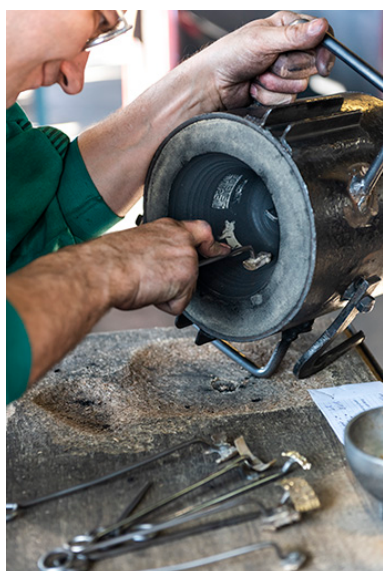
Fabrication du moule : impression de décors dans le moule en creux. Phot. Sonia Dourlot IVR43_20182501081NUC4A
