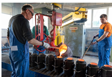
Coulée dans un petit châssis (Yves Obertino éloigne les scories avec une barre métallique). Phot. Sonia Dourlot IVR43_20182501062NUC4A
