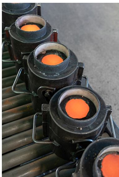
Refroidissement du bronze dans des petits châssis. Phot. Sonia Dourlot IVR43_20182501068NUC4A
