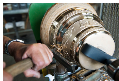
Tournage d'une cloche : position du ciseau. Phot. Sonia Dourlot IVR43_20182501091NUC4A
