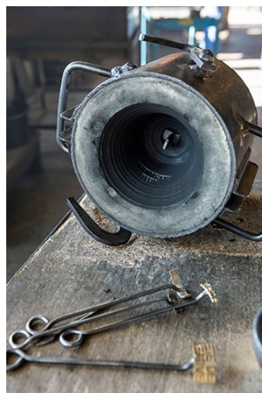
Fabrication du moule : moule en creux avec inscription et outils. Phot. Sonia Dourlot IVR43_20182501080NUC4A
