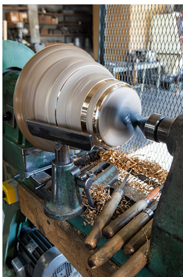
Tournage d'une cloche : la cloche en rotation. Phot. Sonia Dourlot IVR43_20182501088NUC4A
