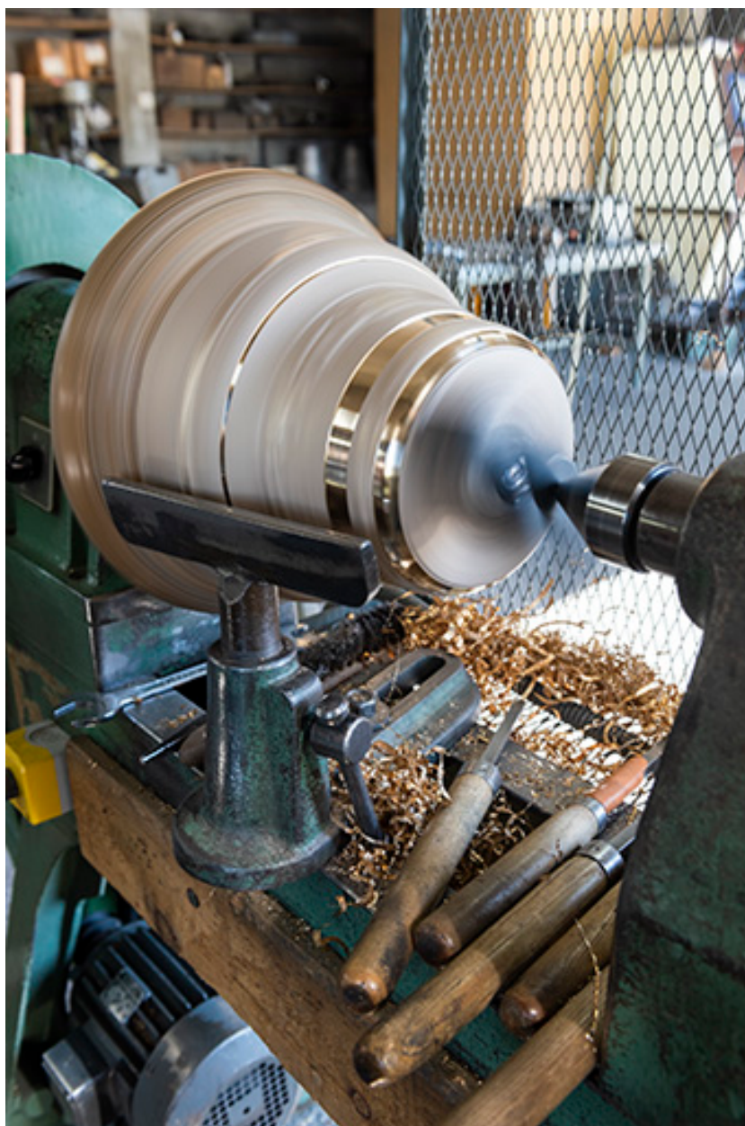
Tournage d'une cloche : la cloche en rotation.
