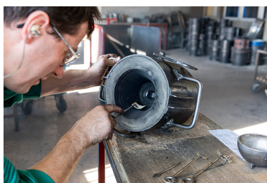
Fabrication du moule : impression d'une inscription dans le moule en creux. Phot. Sonia Dourlot IVR43_20182501079NUC4A
