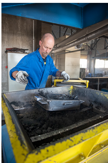
Démoulage. Phot. Sonia Dourlot IVR43_20182501070NUC4A
