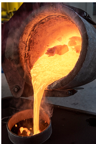
Coulée dans un grand châssis. Phot. Sonia Dourlot IVR43_20182501066NUC4A
