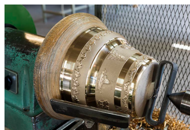
Tournage d'une cloche : la cloche immobile, avec ses bandes avivées par le ciseau. Phot. Sonia Dourlot IVR43_20182501089NUC4A
