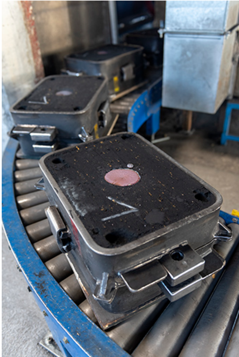
Refroidissement du bronze dans des grands châssis.
