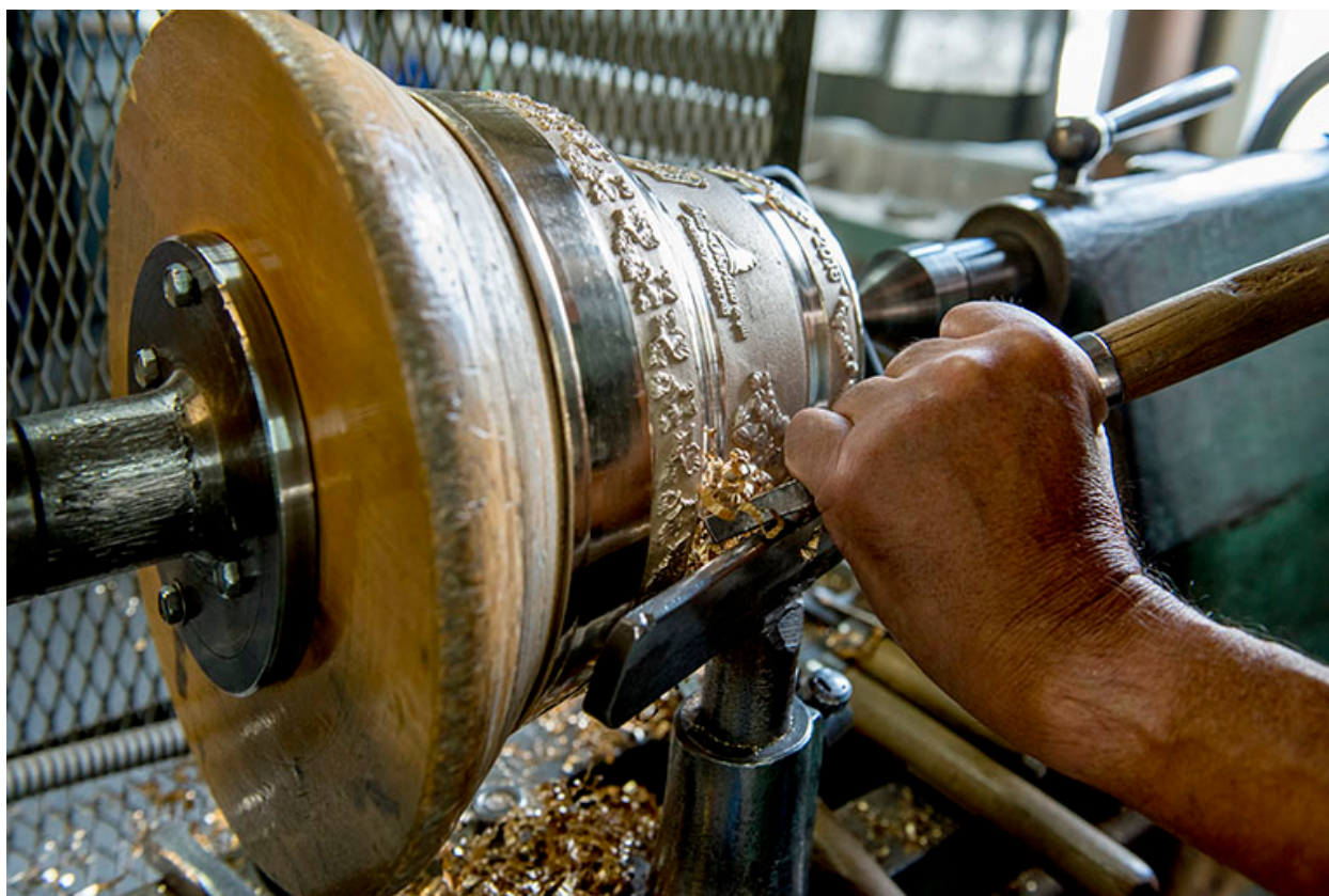
Tournage d'une cloche : position du ciseau.
