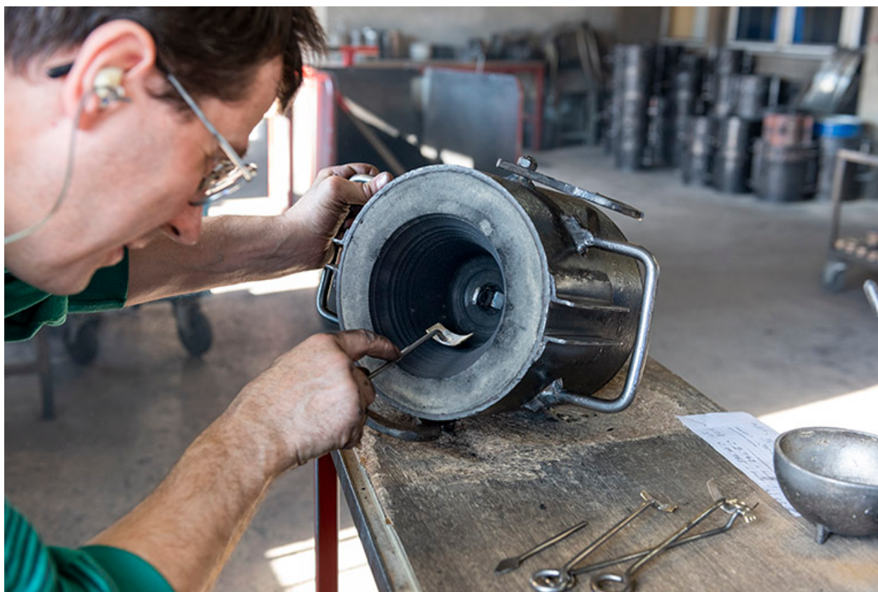
Fabrication du moule : impression d'une inscription dans le moule en creux.
