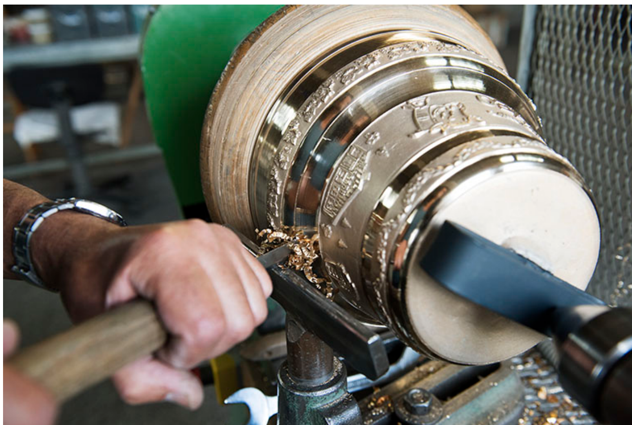
Tournage d'une cloche : position du ciseau.
