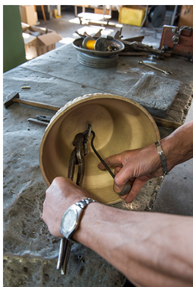
Montage d'un battant. Phot. Sonia Dourlot IVR43_20182501096NUC4A
