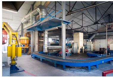
Intérieur de l'atelier au rez-de-chaussée : le convoyeur dans la zone de coulée.
