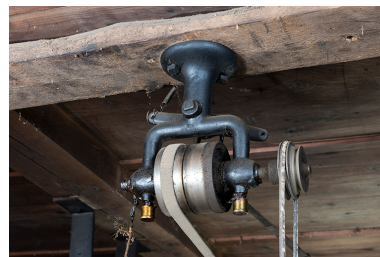
Renvoi de mouvement à deux graisseurs. La fourchette, commandée par la corde à gauche, se devine à l'arrière-plan.
