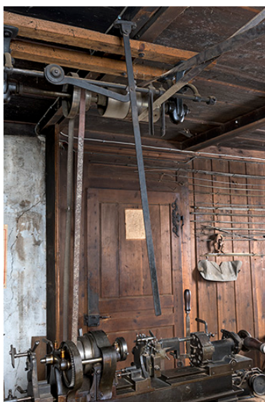
Exemple de disposition : machine à décolleter (rangée de droite). Le levier vertical au plafond permet de changer de poulie la courroie motrice (à droite) tandis qu'une deuxième courroie transmet l'énergie à la machine, équipée d'une poulie étagée.
