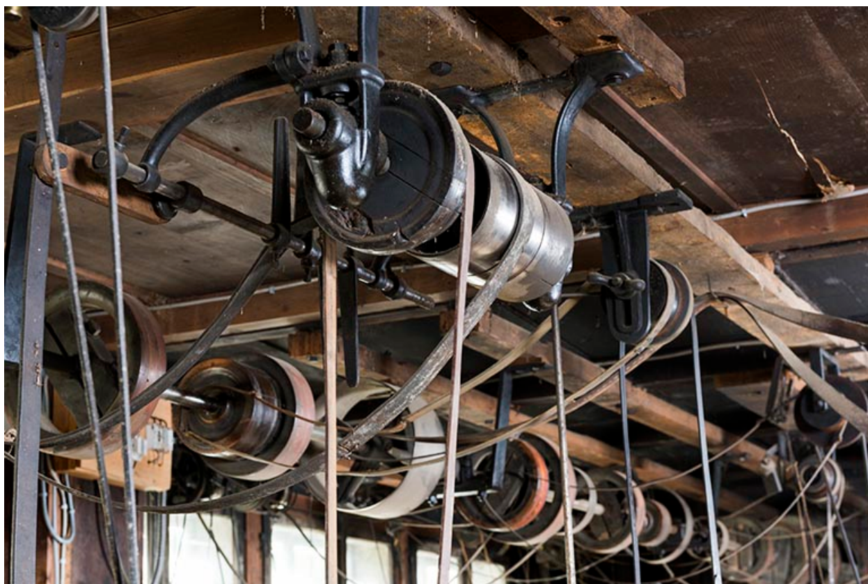
Arbre de transmission secondaire de la rangée centrale (au premier plan) et arbre principal (à l'arrière-plan).
