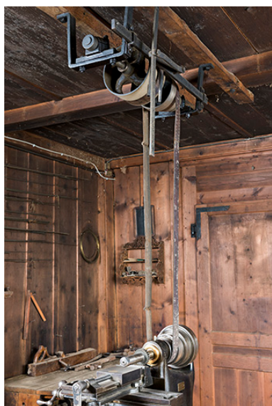
Exemple de disposition : machine à fraiser (rangée de droite). Le levier vertical au plafond permet de changer de poulie la courroie motrice (absente) tandis qu'une deuxième courroie transmet l'énergie à la machine, équipée d'une poulie étagée.
