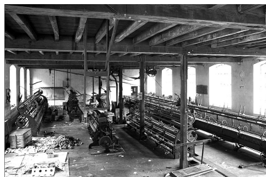
Vue d'ensemble des machines. De gauche à droite, machines Ryo-Catteau (moulineuse et assembleuse étudiées, moulineuse non étudiée) et machine Fouvez (moulineuse non étudiée). Tout à droite, renvideur Asa Lees. Phot. Yves Sancey IVR43_19943901499X
