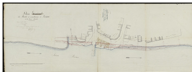
Plan des perrés à construire à Losne et de leurs abords. 1838.
