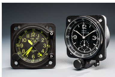
Chronographes de bord Dodane type 11 A (à droite) et sa version actuelle type 211 (à gauche). Phot. Jérôme Mongreville IVR43_20142500316NUC4A
