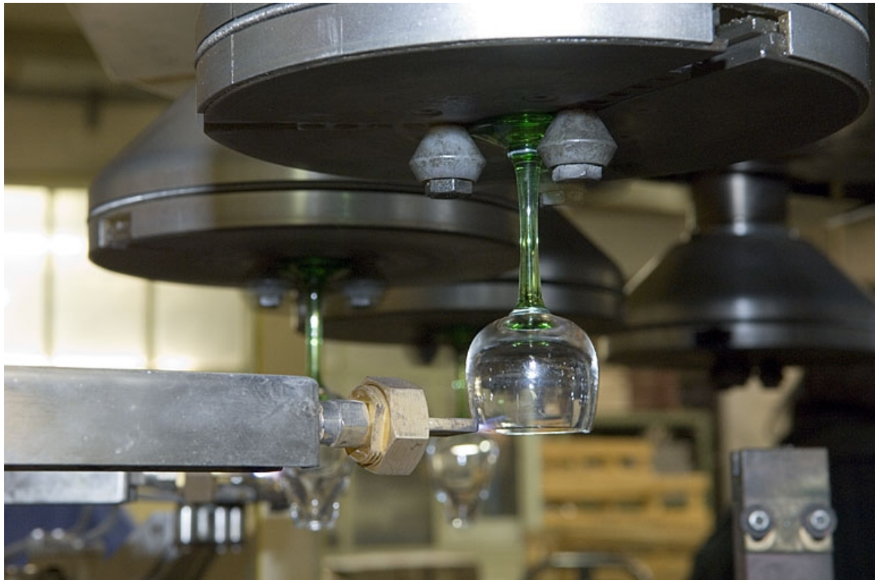
Verrerie de la Rochère : flettage (ou rebrûlage) des bords d'un verre.
