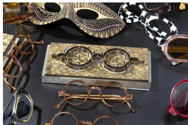
Lunettes en plastique et emporte-pièce ayant servi à leur fabrication. Modèle de lunettes courant jusqu'à la première guerre mondiale. Collection du musée de la Lunette, Morez. Phot. Yves Sancey IVR43_20103900717NUC2A
