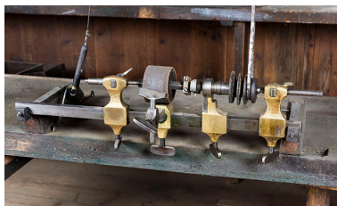
Tour à perche de la rangée centrale, équipé en machine à polir. Phot. Sonia Dourlot IVR43_20172500084NUC4A
