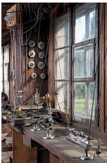
Machines installées derrière la fenêtre multiple : deux tours Lorch et, à l'arrière-plan, une machine à diviser. Phot. Sonia Dourlot IVR43_20172500039NUC4A
