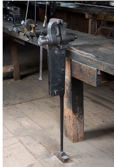
Etau à pied de la rangée centrale, permettant la fixation d'un tour à perche. Phot. Sonia Dourlot IVR43_20172500098NUC4A
