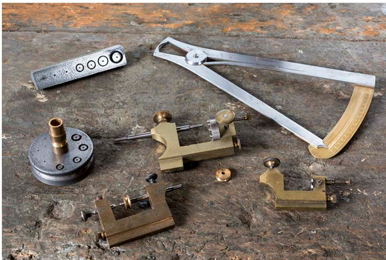
Exemple d'outils fabriqués dans l'atelier : outils à redresser les roues de cylindre (à gauche), au dixième (en haut à droite), à centrer et rapporter les pivots (les trois en bas autour d'un cuivrot, celui du haut étant dit à 12 cornets).
