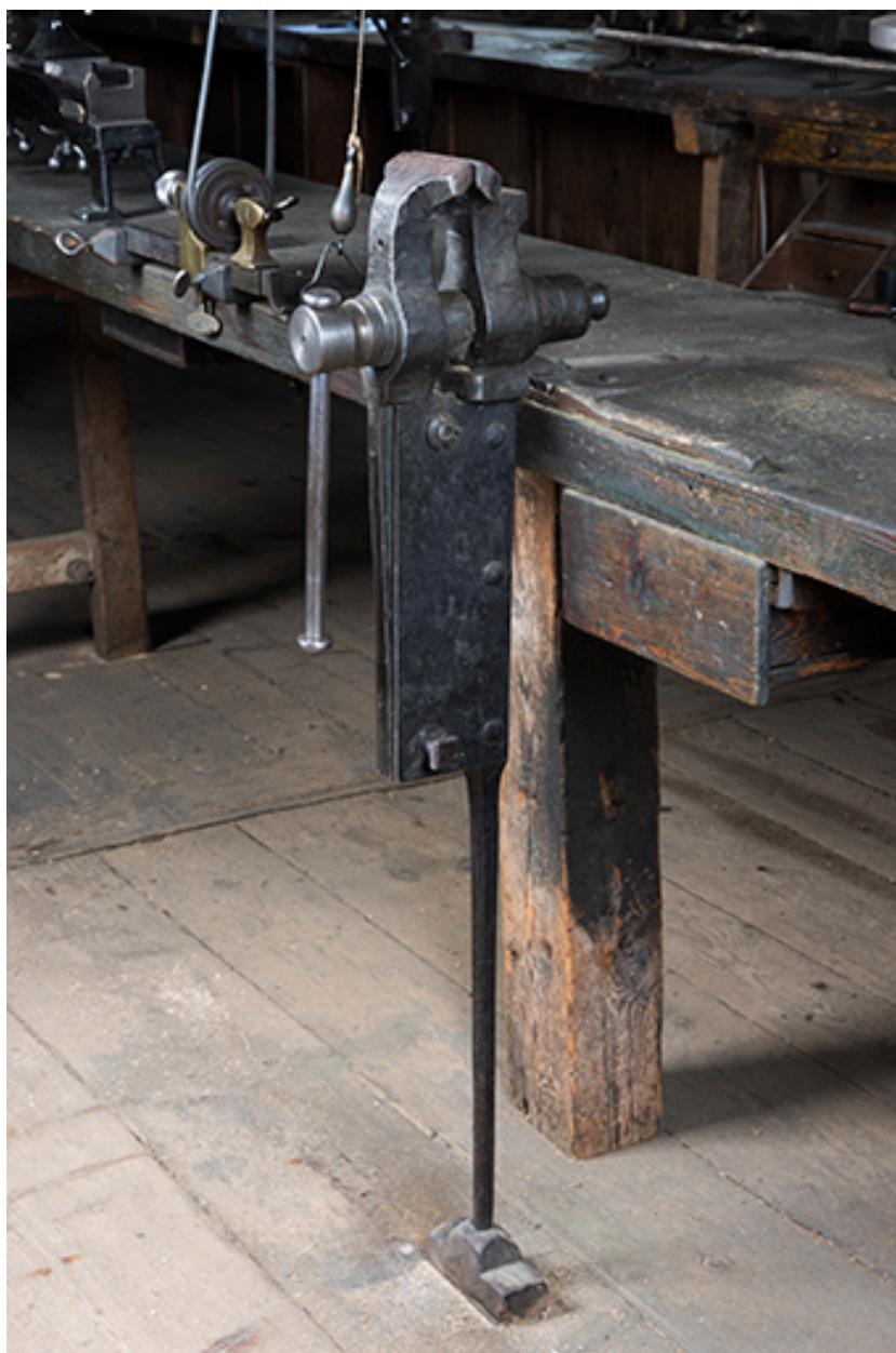
Etau à pied de la rangée centrale, permettant la fixation d'un tour à perche.
