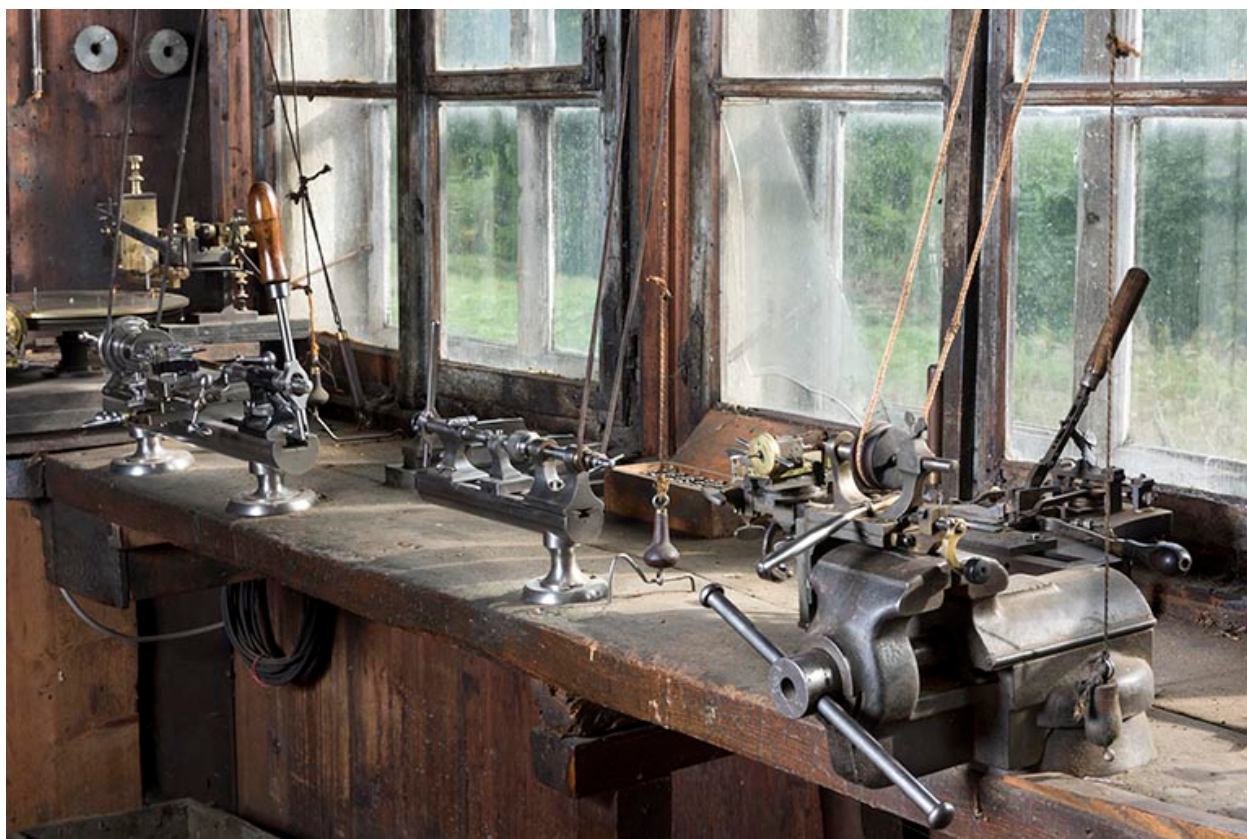
Machines installées derrière la fenêtre multiple : deux tours Lorch et une machine à percer de fabrication artisanale (au premier plan).
