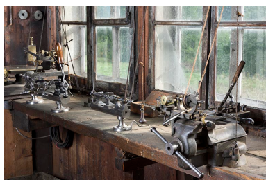
Machines installées derrière la fenêtre multiple : deux tours Lorch et une machine à percer de fabrication artisanale (au premier plan). Phot. Sonia Dourlot IVR43_20172500038NUC4A
