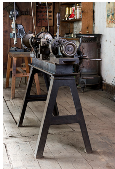
Machine sur pieds de la troisième rangée : machine à décolleter (tour revolver). Phot. Sonia Dourlot IVR43_20172500075NUC4A
