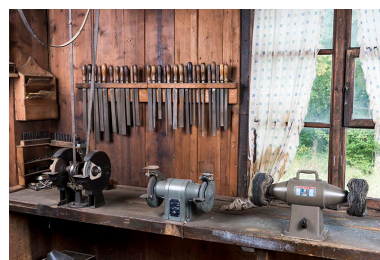
Tourets à polir fixés sur l'établi derrière la fenêtre simple. Phot. Sonia Dourlot IVR43_20172500111NUC4A
