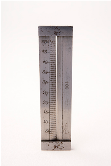
Calibre (jauge), gradué en centièmes de mm. Phot. Sonia Dourlot IVR43_20172500348NUC4A
