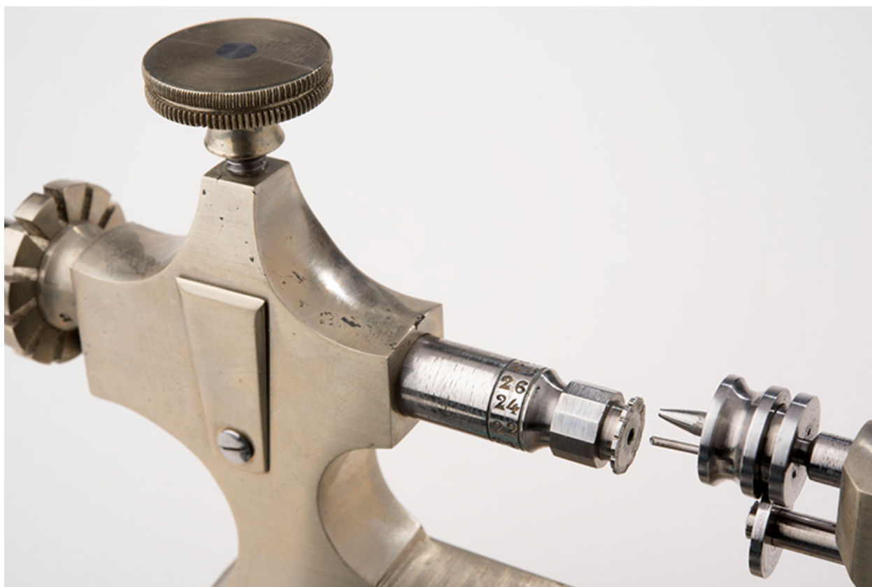
Poupée fixe et broche, montrant l'extrémité à coches.
