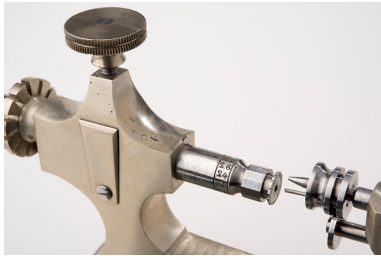
Poupée fixe et broche, montrant l'extrémité à coches. Phot. Sonia Dourlot IVR43_20172500344NUC4A
