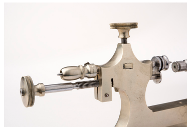
Poupée fixe, avec vis de rappel à gauche et poulie motrice à droite. Phot. Sonia Dourlot IVR43_20172500345NUC4A
