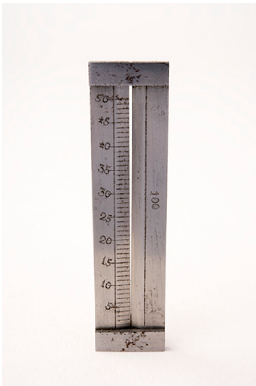
Calibre (jauge), gradué en centièmes de mm.
