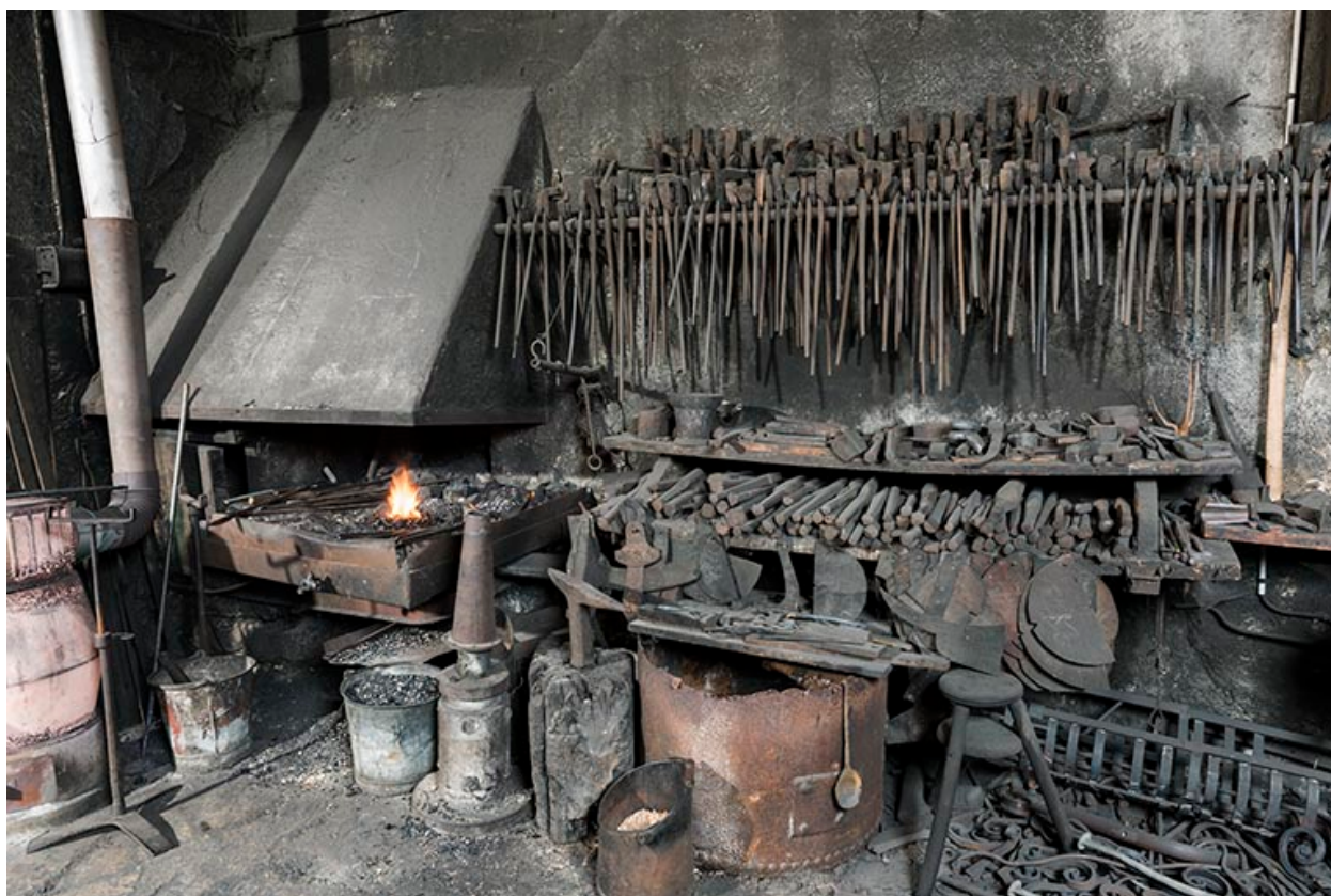
Forge : intérieur de l'atelier de travail à chaud (fournaise et outils de forgeron).
