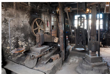
Forge : intérieur de l'atelier de travail à chaud (martinets et mouton). Phot. Sonia Dourlot IVR43_20172501564NUC4A
