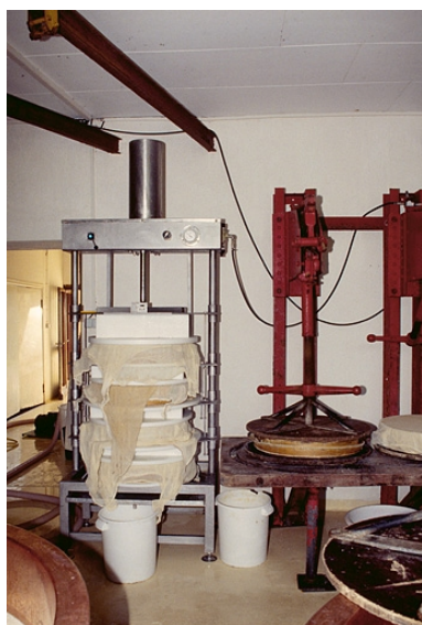
Presse pneumatique et presses à vis. Phot. Jérôme Mongreville IVR43_19953900193ZA
