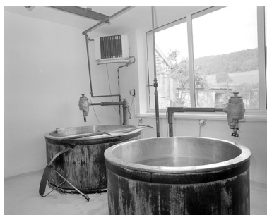
Chaudières, avec brasseur mécanique et tranche-caillé manuel. Phot. Jérôme Mongreville IVR43_19953900141X
