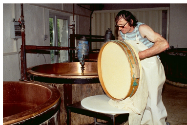
Démoulage d'un fromage : retournement. Phot. Jérôme Mongreville IVR43_19953900198ZA
