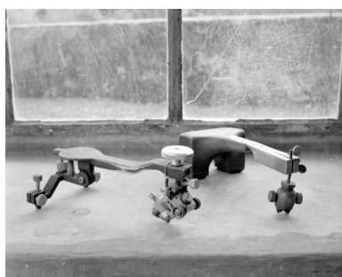
Pincettes de diamantaire et coquilles mécaniques. Phot. Jérôme Mongreville IVR43_19923900456X
