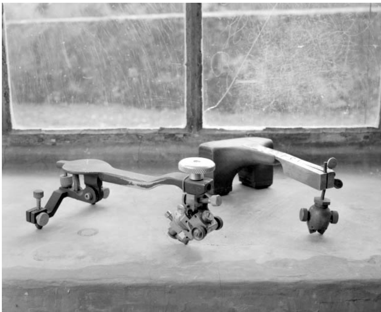
Pinces de diamantaire et coquilles mécaniques.
