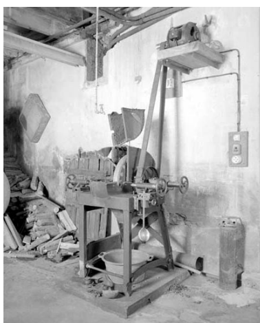
Machine à "roder" (rectifier) les meules de diamantaire. Phot. Jérôme Mongreville IVR43_19923900457X
