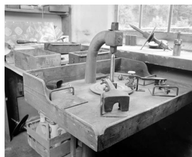
Banc de diamantaire. Près de la fenêtre, meule de diamantaire et pilon (pour fabriquer le bort). Phot. Jérôme Mongreville IVR43_19923900455X
