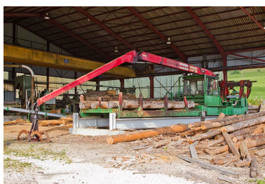
Parc aux grumes : scie sur chariot mobile Herkules. Phot. Yves Sancey IVR43_20132501284NUC2A
