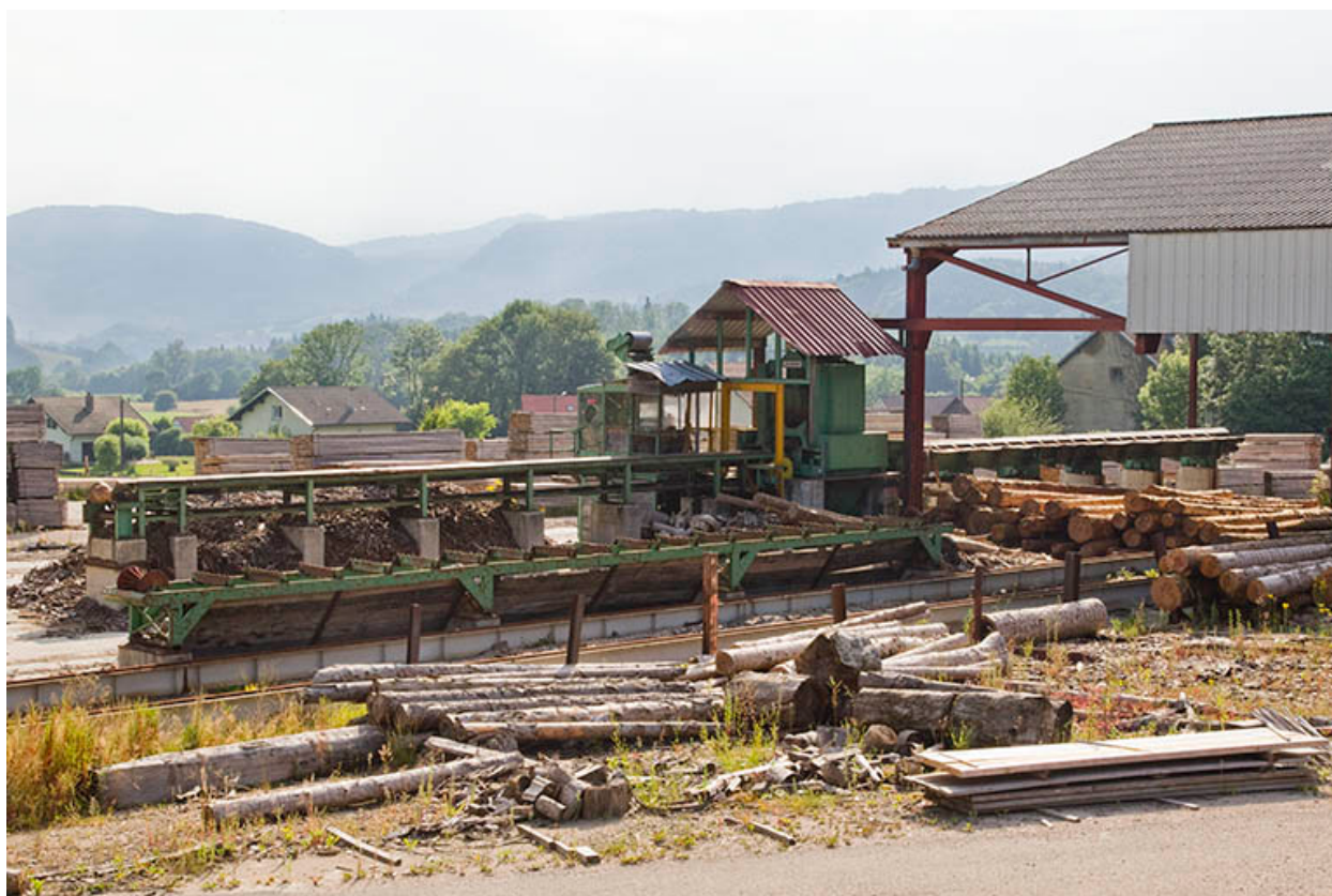
Parc aux grumes : convoyeur et écorceuse Segem.
