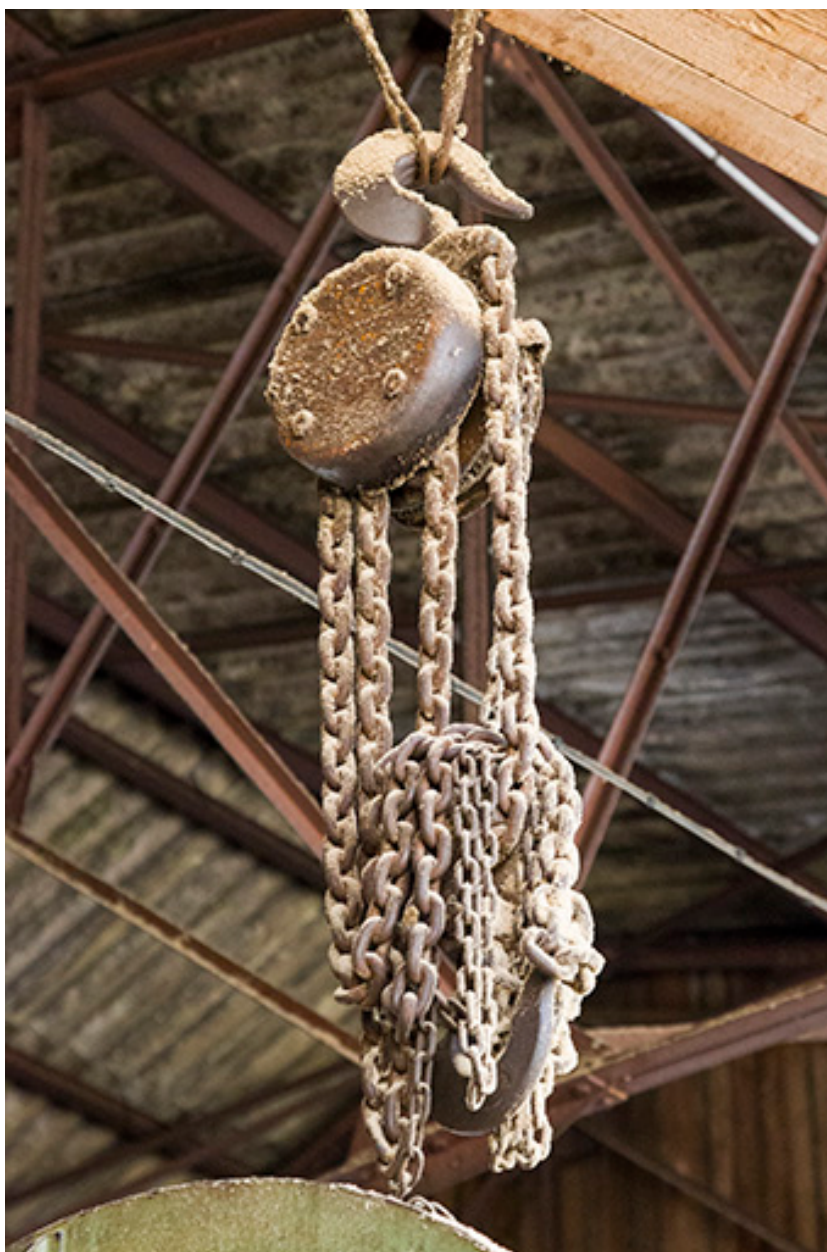
Atelier de fabrication de 1953 : palan manuel.
