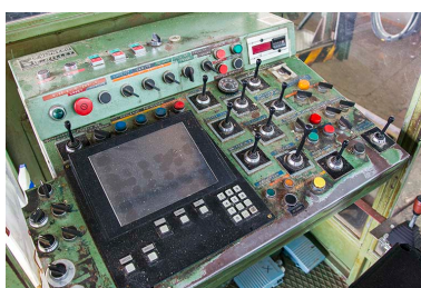
Atelier de fabrication de 1980-1982 : pupitre du poste de commande de la scie Gillet et Vigneau. Phot. Yves Sancey IVR43_20132501291NUC2A
