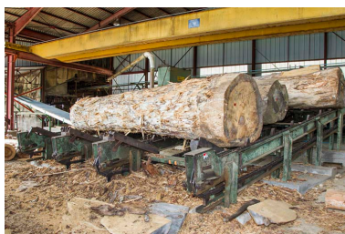
Atelier de fabrication de 1980-1982 : chariot à grumes alimentant la scie Gillet et Vigneau. Phot. Yves Sancey IVR43_20132501288NUC2A
