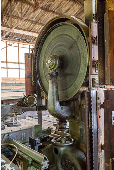
Atelier de fabrication de 1953 : volant et lame de la scie CIP Marqcol (détail). Phot. Yves Sancey IVR43_20132501298NUC2A
