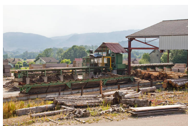
Parc aux grumes : convoyeur et écorceuse Segem. Phot. Yves Sancey IVR43_20132501280NUC2A
