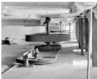
Poulies de transmission dans le couloir des câbles. Phot. Yves Sancey IVR43_19999000291X
