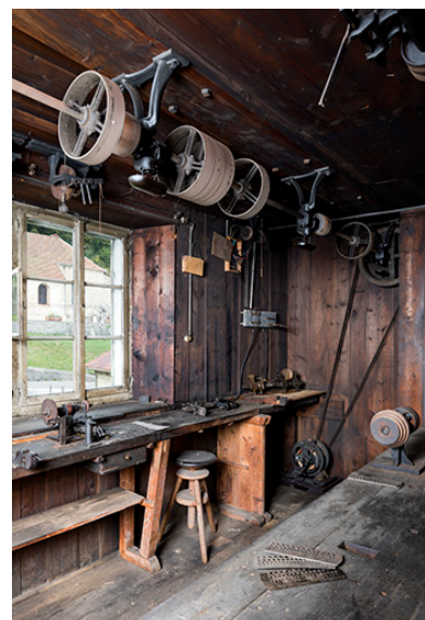
L'atelier, avec moteur électrique et transmissions.
