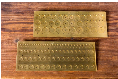
Calibres aux roues, en laiton. Phot. Sonia Dourlot IVR43_20172500161NUC4A
