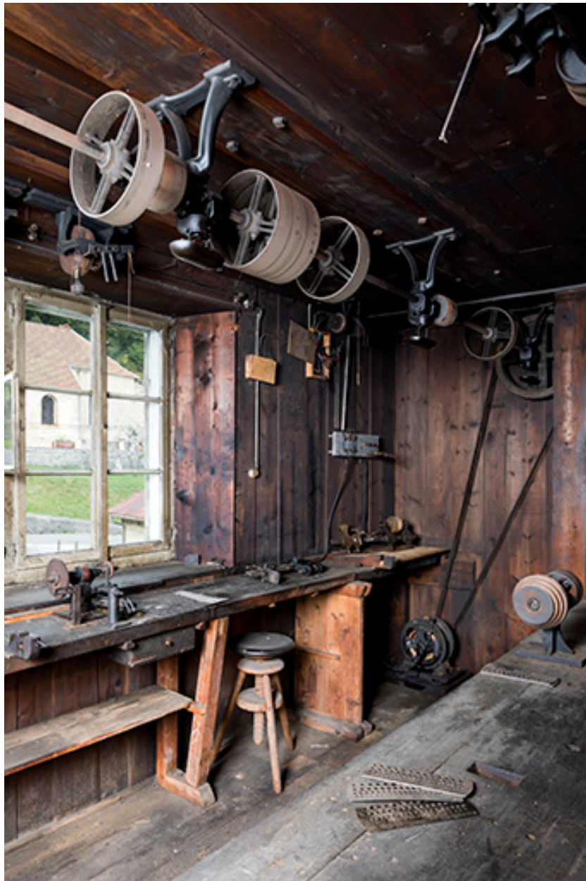
L'atelier, avec moteur électrique et transmissions.
