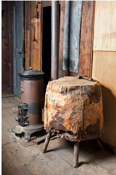
L'atelier : poêle et "tas" en bois pour redresser les calibres. Phot. Sonia Dourlot IVR43_20172500158NUC4A
