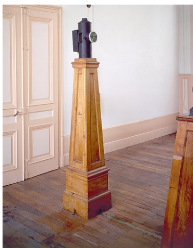
L'une des deux lanternes permettant d'éclairer les cercles gradués de la lunette. Phot. Jérôme Mongreville
