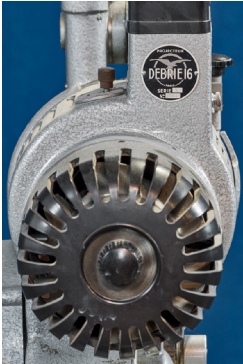
Arrière : moteur électrique et plaque signalétique.
