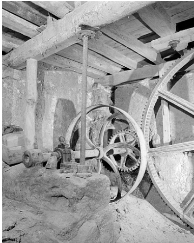
Roue entraînée par le rouet et transmettant le mouvement au châssis multiple. Phot. Jérôme Mongreville IVR43_19963901317X
