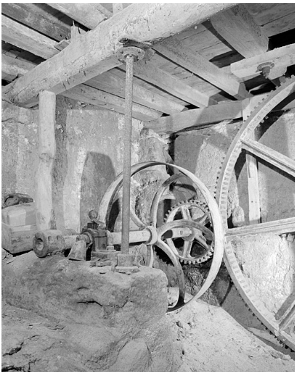
Roue entraînée par le rouet et transmettant le mouvement au chassis multiple.
