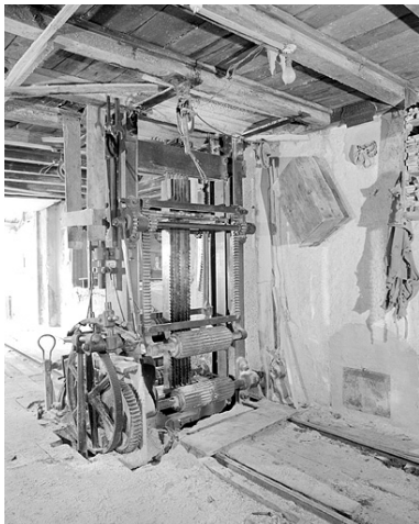
Châssis multiple. Phot. Jérôme Mongreville IVR43_19963901316X
