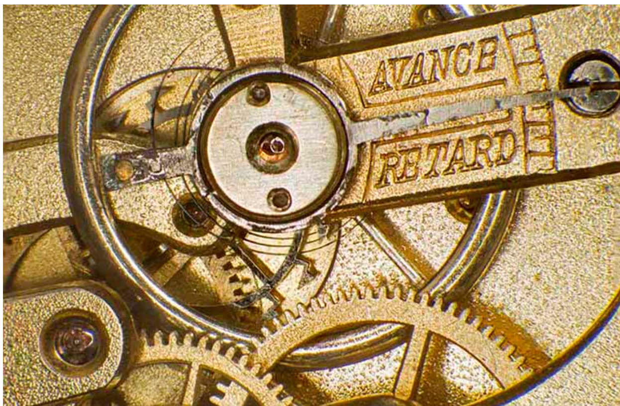
Mécanisme de réglage de la marche diurne : raquette sur le pont de balancier.
