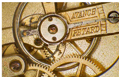
Mécanisme de réglage de la marche diurne : raquette sur le pont de balancier.
