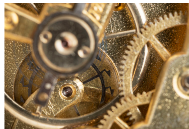
Détail du rouage : la roue de cylindre plate (sombre) est visible à l'arrière du balancier.
