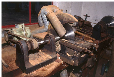
Vue d'ensemble de la scie de gauche, servant au calibrage (dressage des côtés). Phot. Jérôme Mongreville IVR43_20003901046ZA
