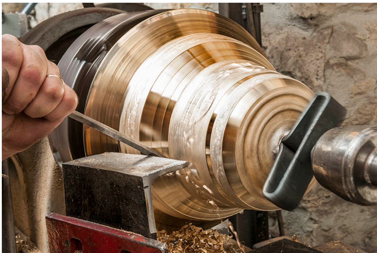
Fonderie de cloches Charles Obertino à Labergement-Sainte-Marie : tournage d'une cloche.
