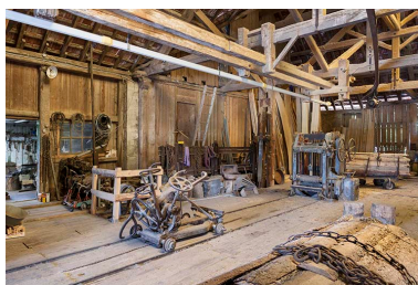
Scierie Thiébaud, à Labergement- Sainte-Marie : châssis de scie multilame Socolest. Phot. Jérôme Mongreville IVR43_20162500427NUC4A
