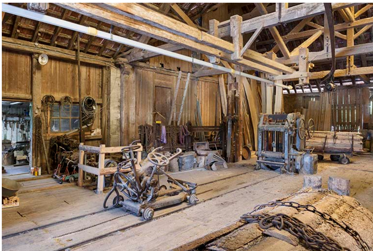
Scierie Thiébaud, à Labergement-Sainte-Marie : châssis de scie multilame Socolest.
