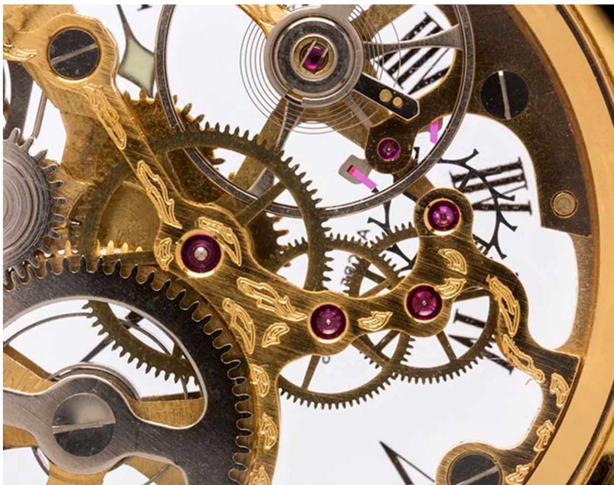
Face inférieure : balancier, ancre, roue d'ancre et rouage.
