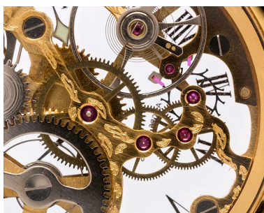
Face inférieure : balancier, ancre, roue d'ancre et rouage.
