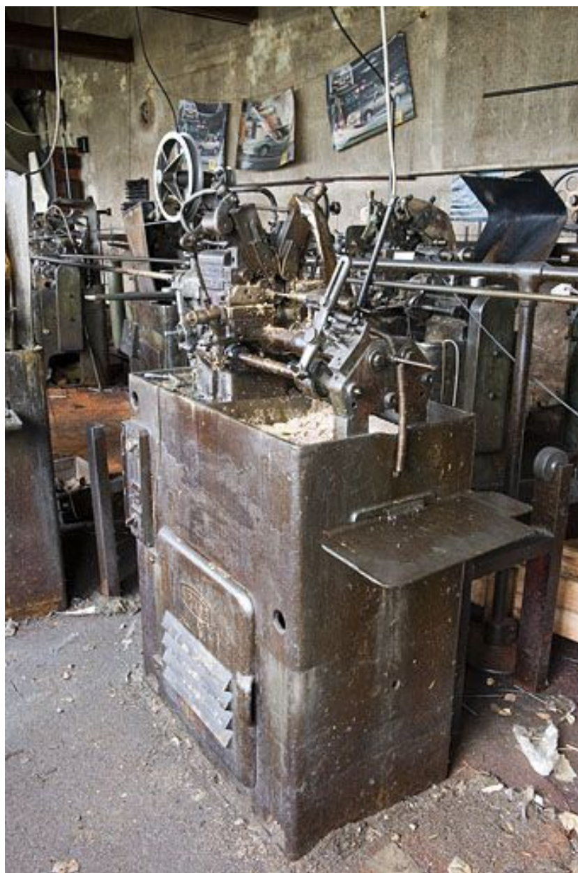
Atelier primitif. Machine à décolleter.
