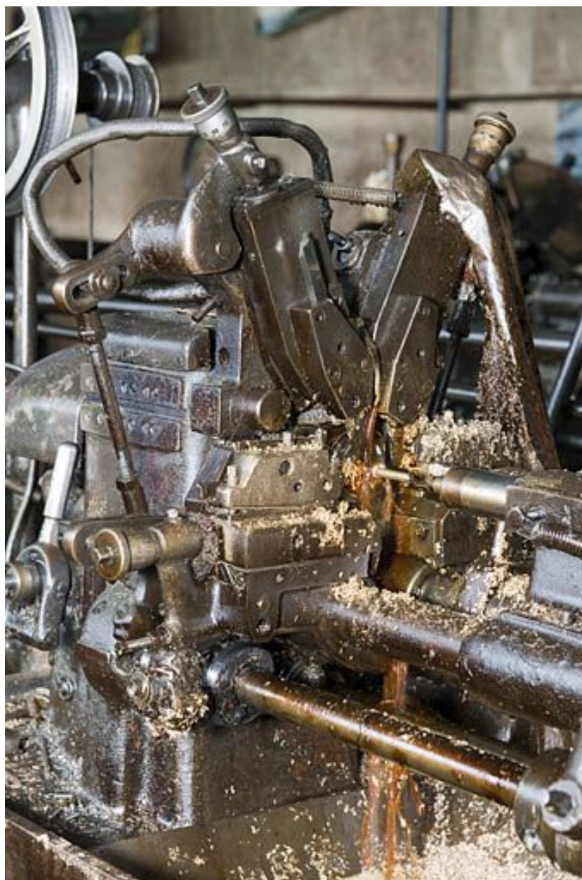
Atelier primitif. Machine à décolleter en action.
