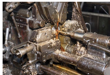
Atelier primitif. Outils de coupe d'une machine à décolleter. Phot. Jérôme Mongreville IVR43_20112501473NUC4A
