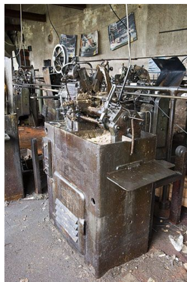
Atelier primitif. Machine à décolleter. Phot. Jérôme Mongreville IVR43_20112501474NUC4A
