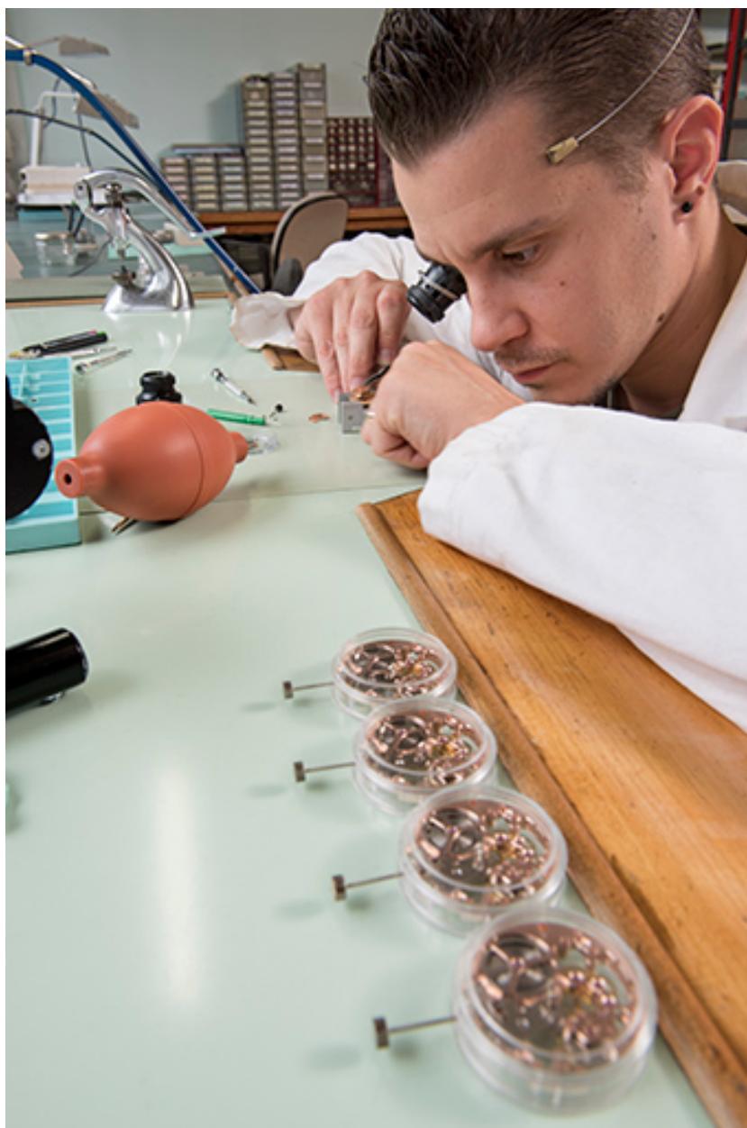
Horloger à l'établi : assemblage d'une montre.
