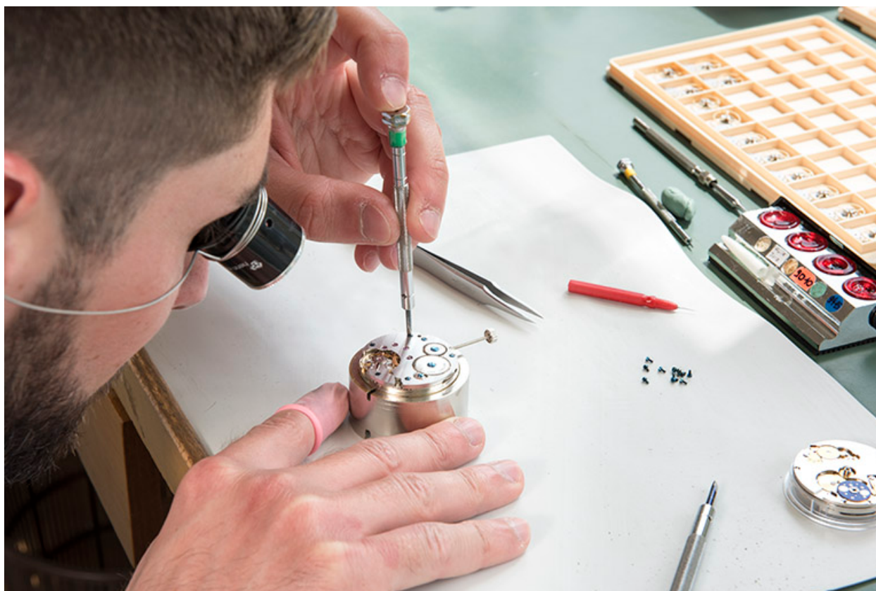
Horloger à l'établi : assemblage d'une montre.
