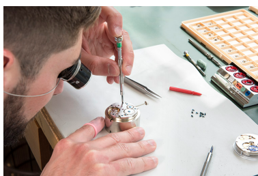
Horloger à l'établi : assemblage d'une montre. Phot. Sonia Dourlot IVR43_20182501110NUC4A
