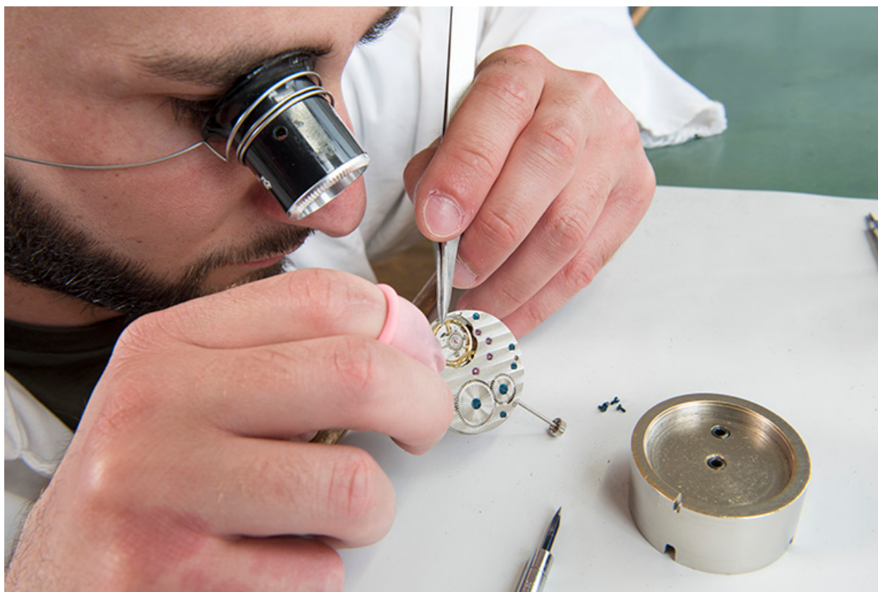
Horloger à l'établi : assemblage d'une montre.
