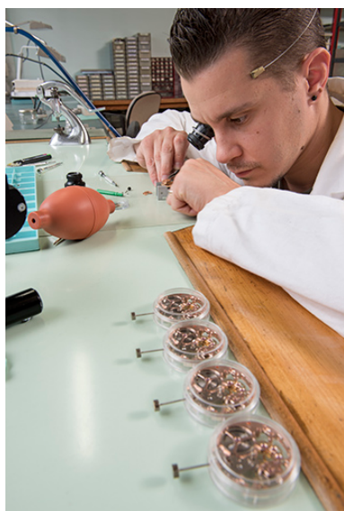
Horloger à l'établi : assemblage d'une montre. Phot. Sonia Dourlot IVR43_20182501113NUC4A
