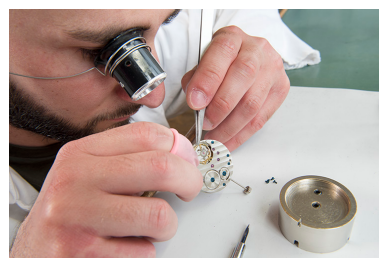
Horloger à l'établi : assemblage d'une montre. Phot. Sonia Dourlot IVR43_20182501111NUC4A
