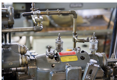
Le système de lubrification. Phot. Jérôme Mongreville IVR43_20142500719NUC2A
