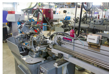
La machine côté poupée mobile et son ravitailleur. Phot. Jérôme Mongreville IVR43_20142500722NUC2A
