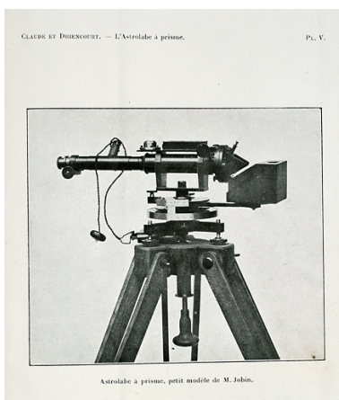
Astrolabe à prisme, petit modèle de M. Jobin, 1910. Phot. Yves Sancey IVR43_20072500862NUCA
