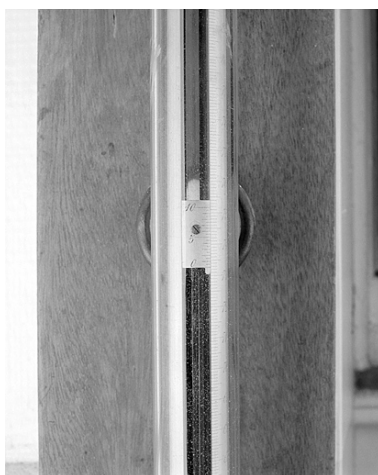
Le vernier, avec à l'arrière le réflecteur pour lire les graduations. Phot. Jérôme Mongreville IVR43_20032501075X
