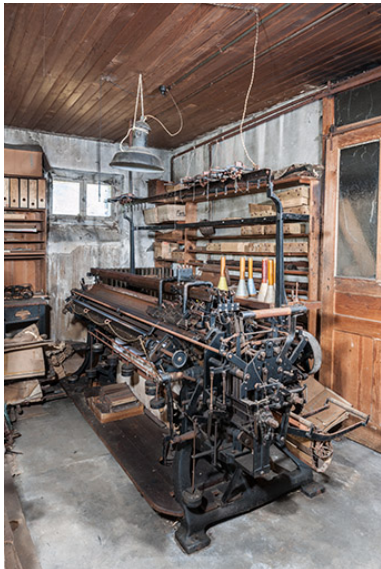
Machine à tricoter à plat. Phot. Jérôme Mongreville IVR43_20142500224NUC4A
