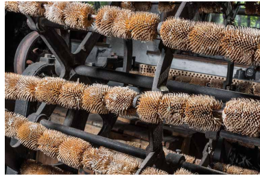
Machine à carder rotative : les cardères à foulon. Phot. Jérôme Mongreville IVR43_20142500228NUC4A
