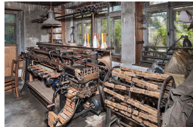
Machine à tricoter à plat (métier à mailles retournées Stoll & C°, à gauche) et machine à carder rotative (à droite). Phot. Jérôme Mongreville IVR43_20142500226NUC4A
