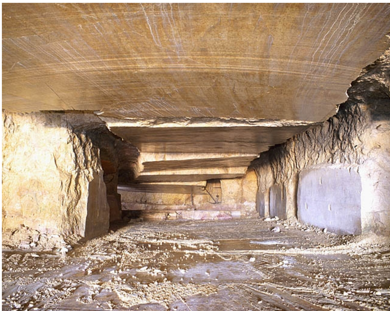
Intérieur, partie centrale, depuis une entrée. Au fond à droite, poulies de renvoi du fil hélicoïdal.
