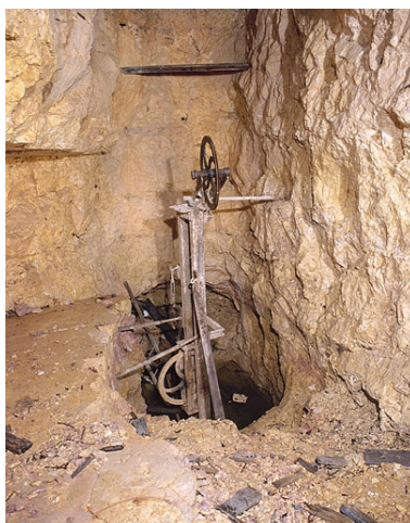
Intérieur, partie centrale, poulies de renvoi du fil hélicoïdal. Phot. Yves Sancey IVR43_19973900155XA
