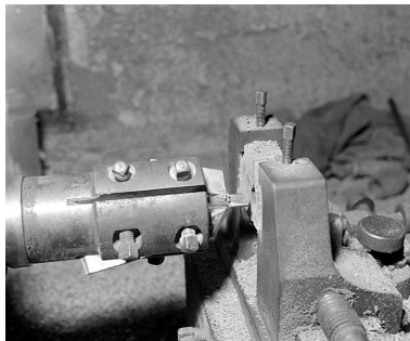
Détail de la mèche et du support de la tête de pipe. Phot. Jérôme Mongreville IVR43_20003900996X
