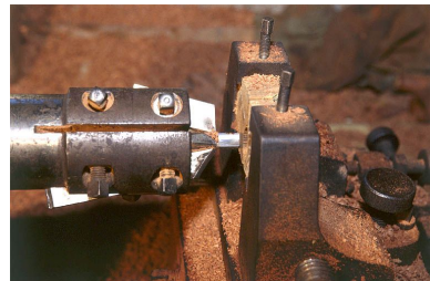
Détail de la mèche et du support de la tête de pipe. Phot. Jérôme Mongreville IVR43_20003900997ZA
