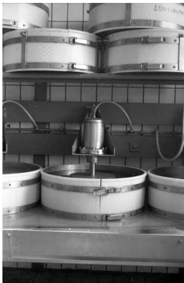
Presse hydraulique. Phot. Laurent Poupard IVR43_19903900615Z
