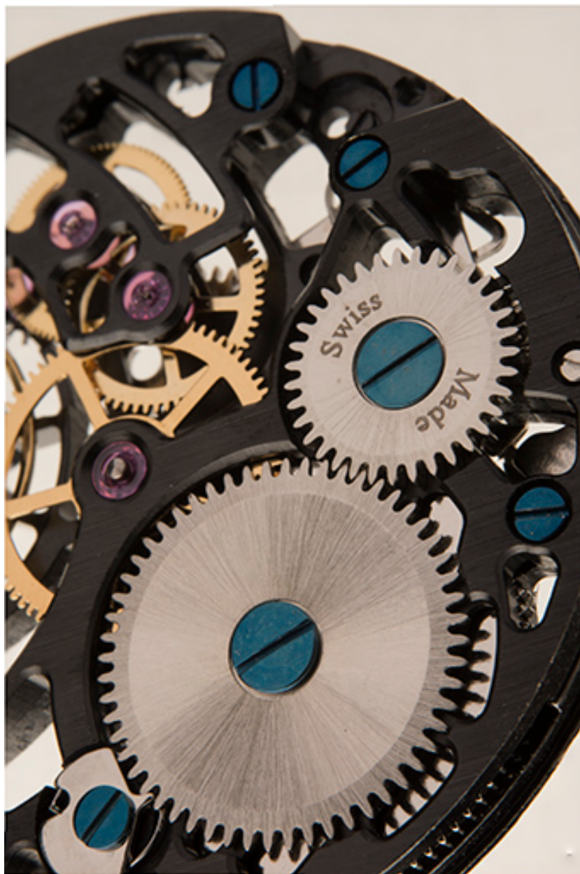
Mouvement noir, détail : rochet et roue de couronne.
