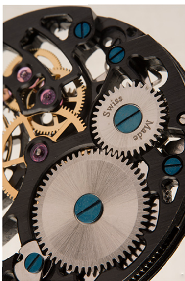
Mouvement noir, détail : rochet et roue de couronne. Phot. Sonia Dourlot IVR43_20182501159NUC4A
