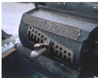
Détail de la boîte de vitesses. Phot. Yves Sancey IVR43_20022500893XA
