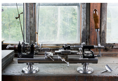
Grand tour, vu de face. A droite, un support d'outil à main. Phot. Sonia Dourlot IVR43_20172500131NUC4A
