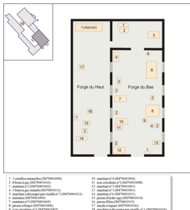
Plan de localisation des machines de la ligne de fabrication des outils forgés. Dess. André Céréza IVR43_20057000170NUDA
