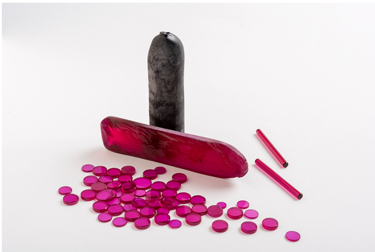
Boules (ou poires) de rubis synthétiques, baguettes et rondelles réalisées à l'atelier.
