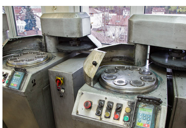
Atelier de polissage : machines à polir à brosse.
