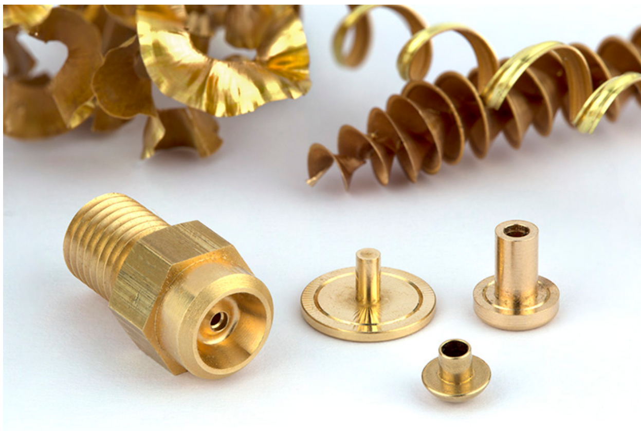
Pièces réalisées par décolletage. A gauche, un gicleur de chaudière (dépourvu de sa pastille en rubis).
