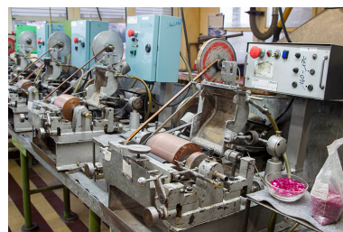
Atelier de taille du rubis : machines à usiner par abrasion (machines suisses Bocadero).
