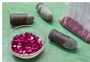
Boules (ou poires) de rubis synthétiques et rondelles réalisées à l'atelier.
