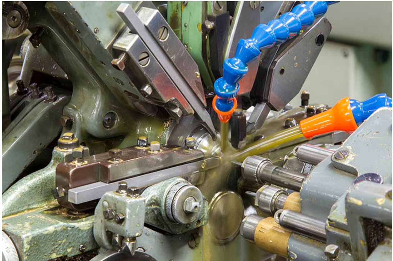
Machine à décolleter ancienne : lubrification de la pièce et des outils.
