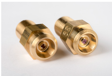
Gicleurs de chaudière avant et après montage de la pastille en rubis synthétique. Phot. Sonia Dourlot IVR43_20142501935NUC4A
