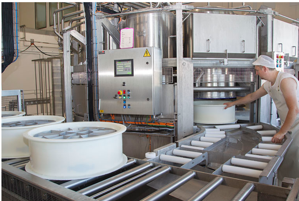
Fabrication : sortie du soutirage sous vide.
