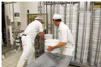
Fabrication du morbier : mise sous presse. Phot. Sonia Dourlot IVR43_20142500775NUC2A
