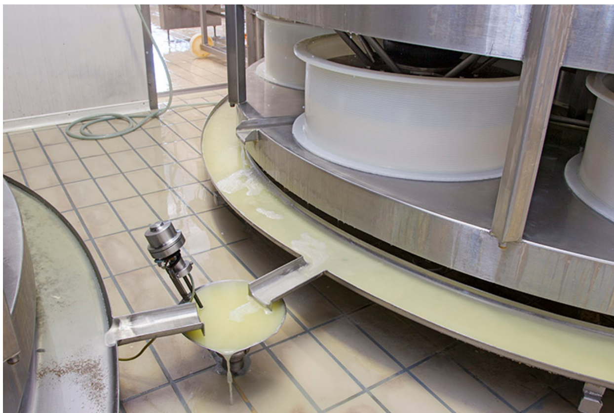
Fabrication : récupération du sérum au pied des presses tournantes.
