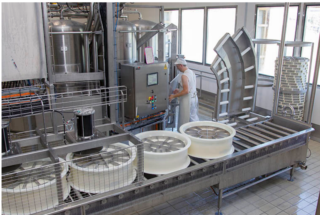
Fabrication : sortie du soutirage sous vide.
