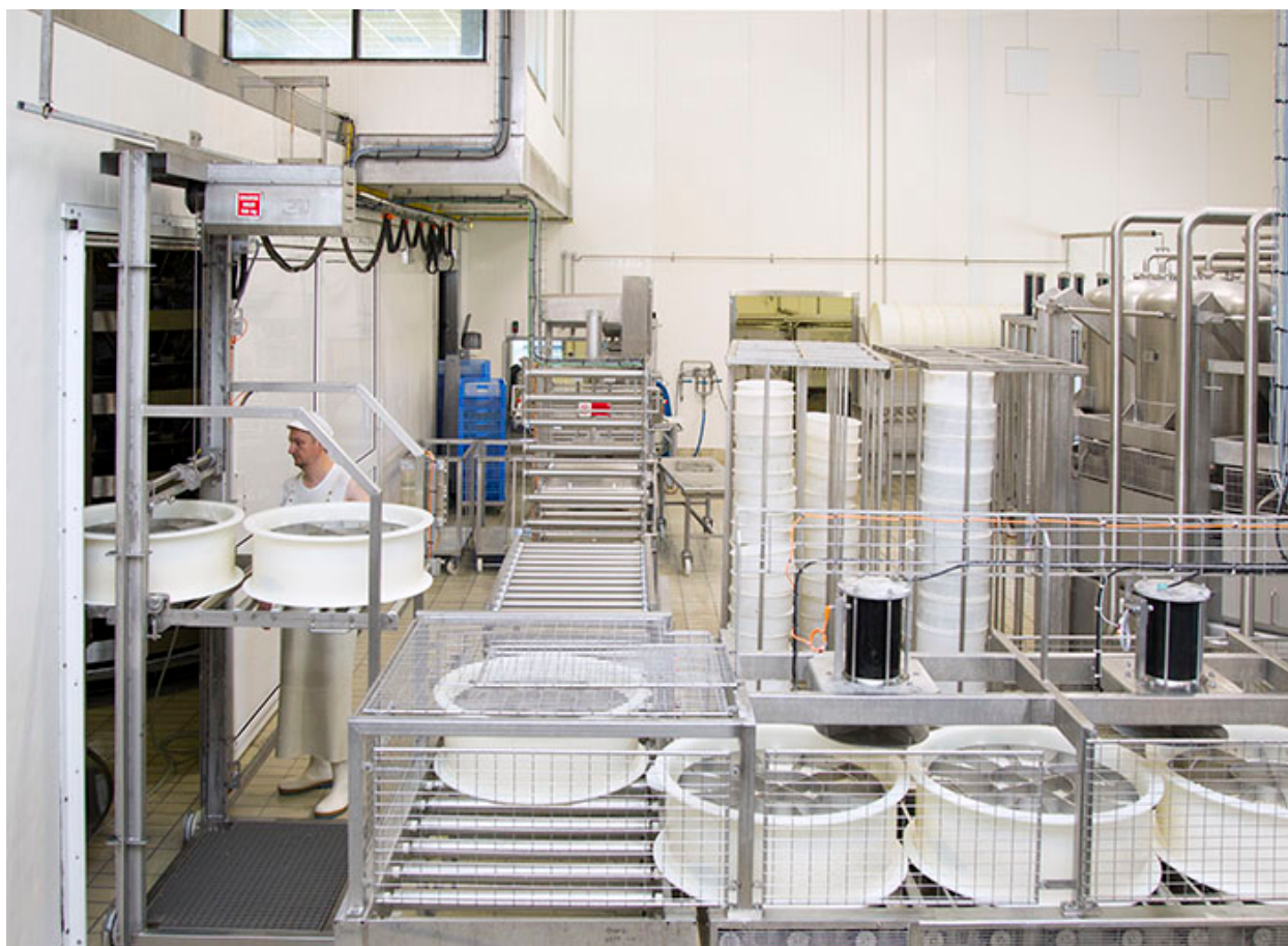
Fabrication : convoyage des moules jusqu'à la presse tournante.
