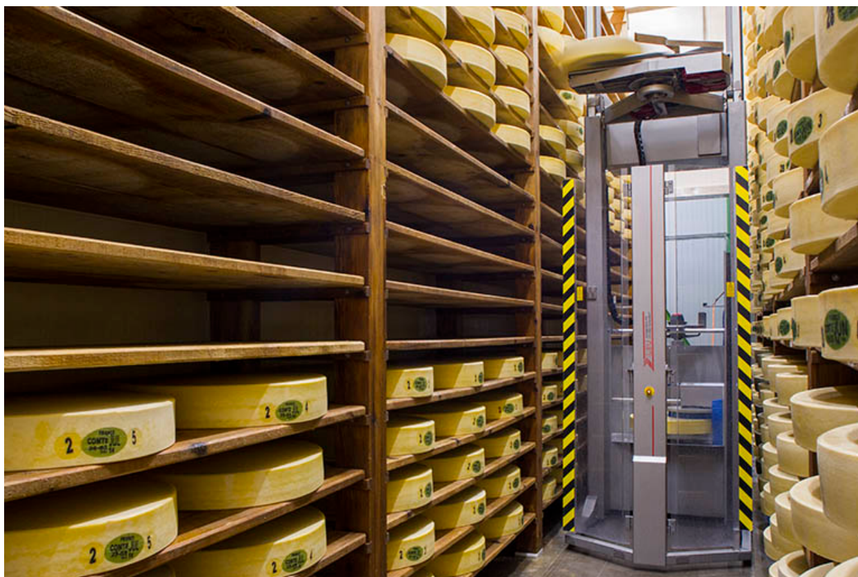
Affinage du comté : le robot de soins en action.
