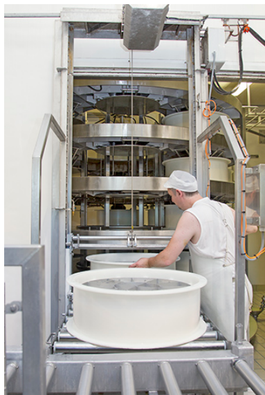
Fabrication : insertion d'un moule dans la presse tournante. Phot. Sonia Dourlot IVR43_20142500780NUC2A
