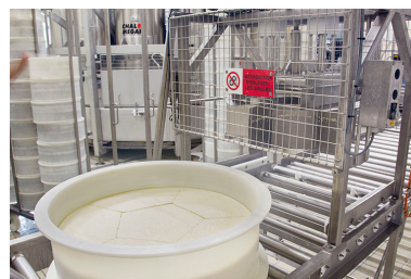
Fabrication du morbier : pain de caillé découpé, dans son moule. Phot. Sonia Dourlot IVR43_20142500768NUC2A
