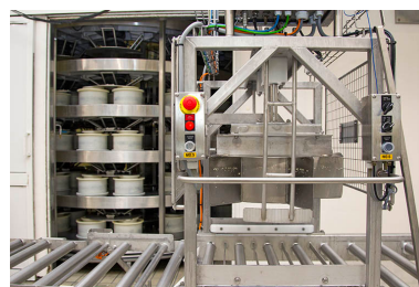
Fabrication du morbier : presse à découper. Phot. Sonia Dourlot IVR43_20142500765NUC2A
