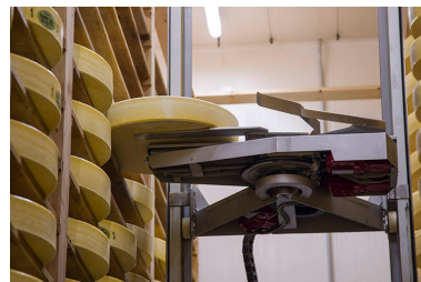
Affinage du comté : robot prenant la meule. Phot. Sonia Dourlot IVR43_20142500757NUC2A
