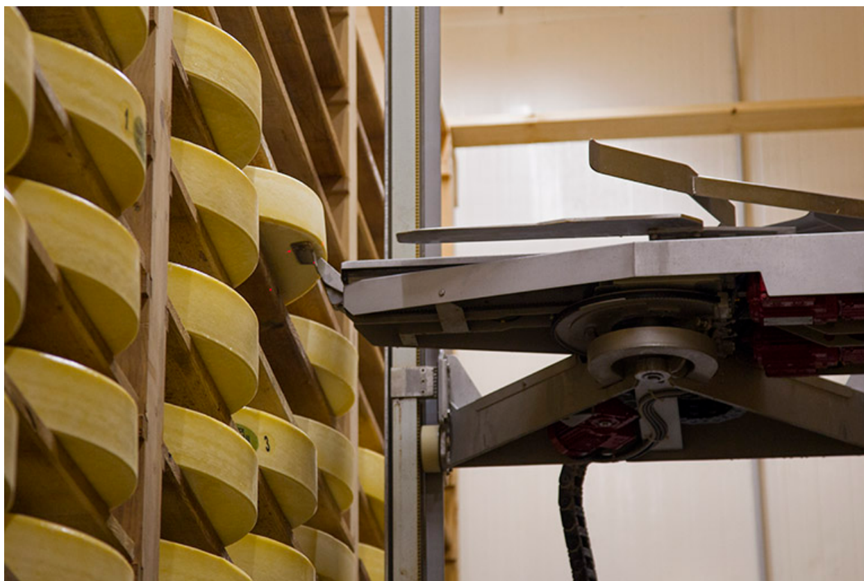
Affinage du comté : robot soulevant une meule.
