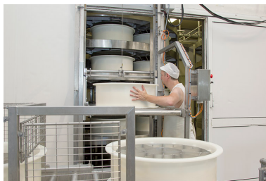
Fabrication : insertion d'un moule dans la presse tournante. Phot. Sonia Dourlot IVR43_20142500779NUC2A
