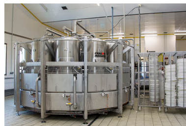
Atelier de fabrication : le soutirage sous vide. Phot. Sonia Dourlot IVR43_20142500748NUC2A
