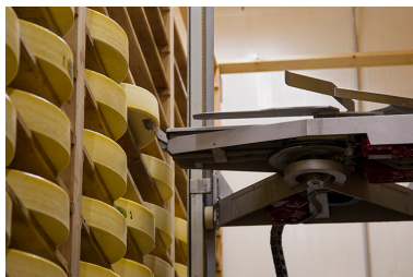
Affinage du comté : robot soulevant une meule. Phot. Sonia Dourlot IVR43_20142500756NUC2A
