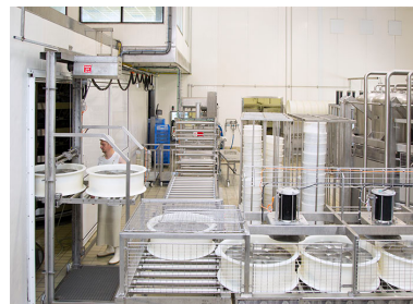
Fabrication : convoyage des moules jusqu'à la presse tournante. Phot. Sonia Dourlot IVR43_20142500781NUC2A
