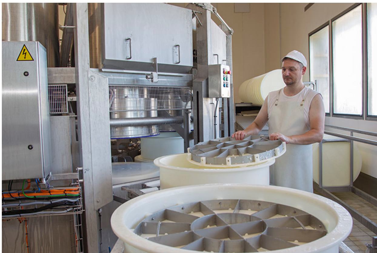
Fabrication : mise en place du couvercle sur le moule à comté.
