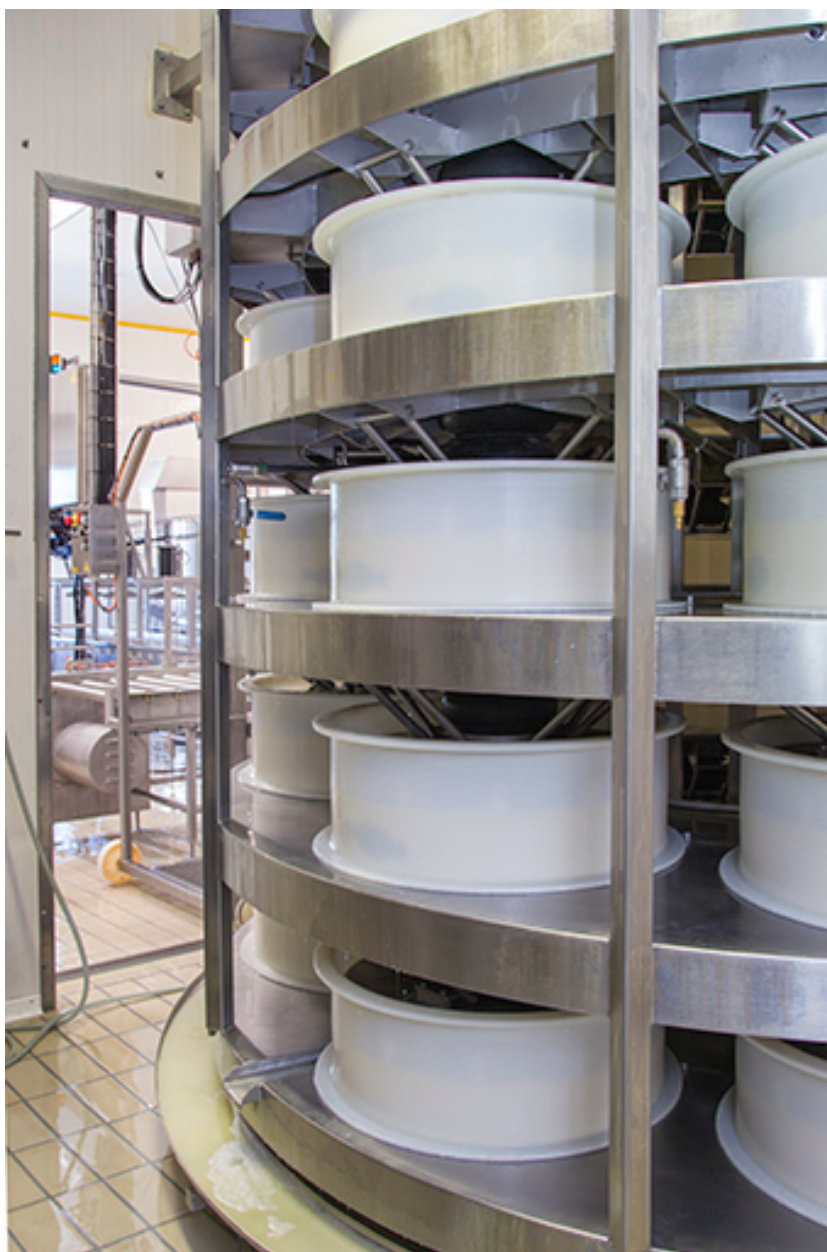
Fabrication : pressage des comtés.
