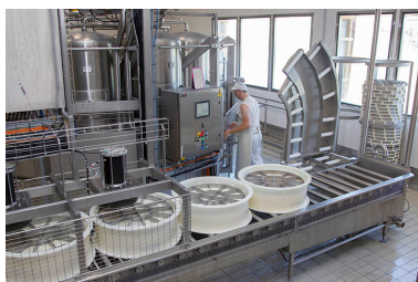
Fabrication : sortie du soutirage sous vide. Phot. Sonia Dourlot IVR43_20142500747NUC2A
