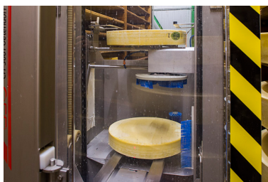
Affinage du comté : échange de meules dans le robot de soins. Phot. Sonia Dourlot IVR43_20142500753NUC2A
