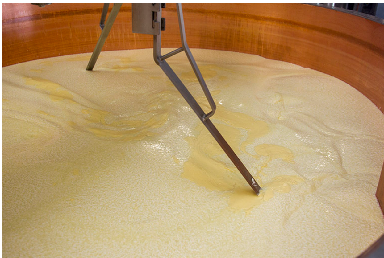
Fabrication : chauffage et brassage du lait.
