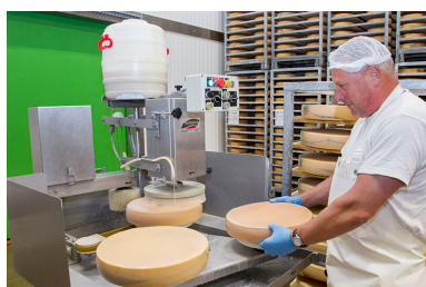
Affinage du morbier : frottage de la meule sous un filet de saumure. Phot. Sonia Dourlot IVR43_20142500786NUC2A
