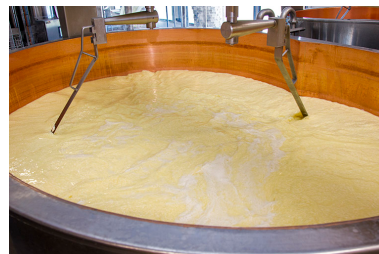
Fabrication : chauffage et brassage du lait. Phot. Sonia Dourlot IVR43_20142500763NUC2A
