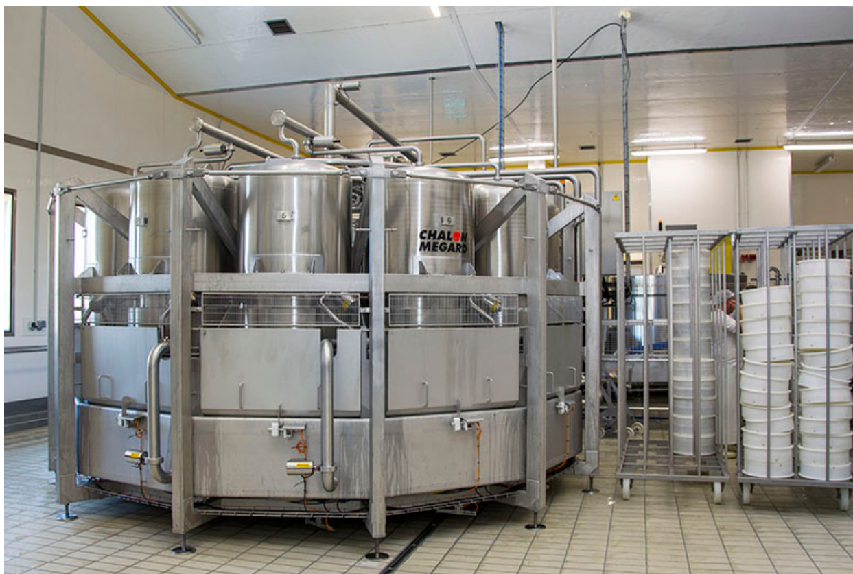
Atelier de fabrication : le soutirage sous vide.
