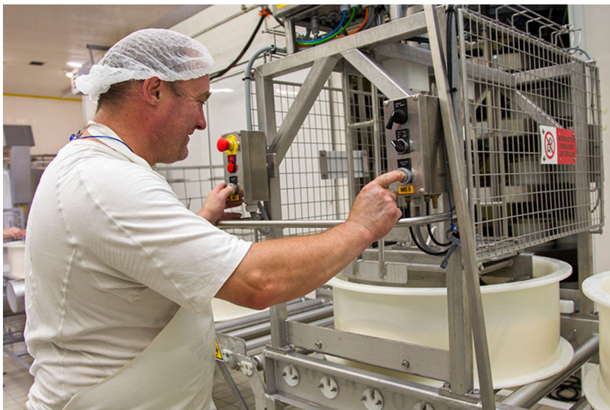
Fabrication du morbier : découpage du pain de caillé dans son moule.
