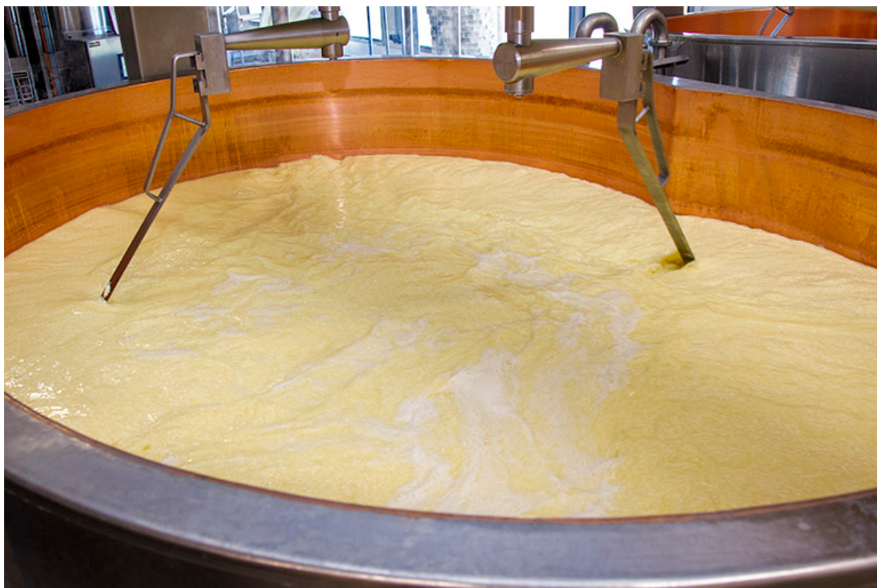
Fabrication : chauffage et brassage du lait.
