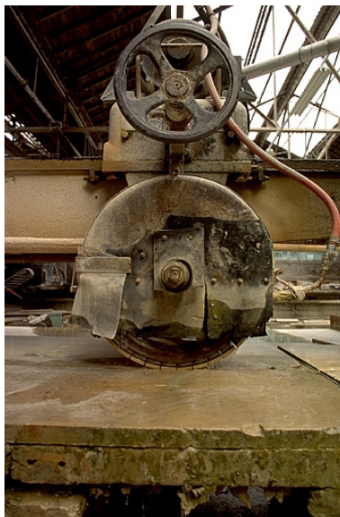
Débiteuse nord : détail de l'organe de sciage. Phot. Yves Sancey IVR43_19973901776ZA
