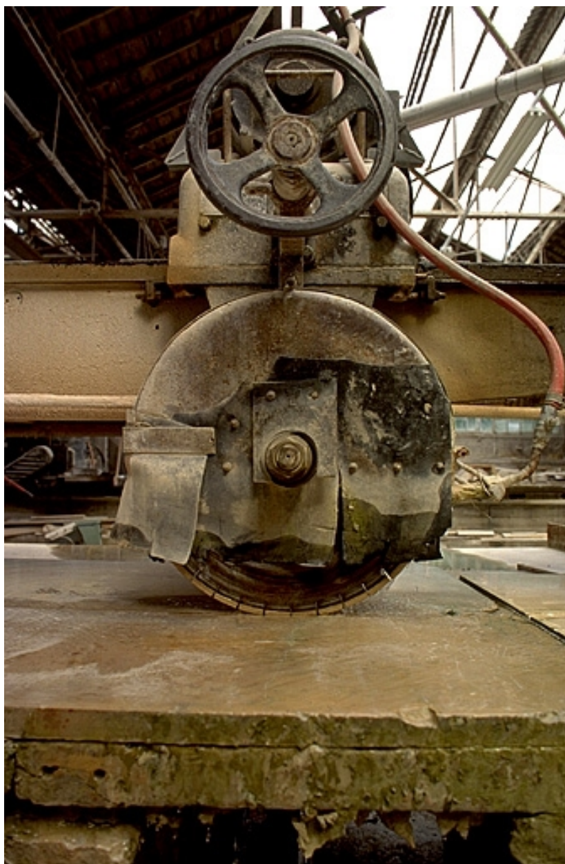
Débiteuse nord : détail de l'organe de sciage.
