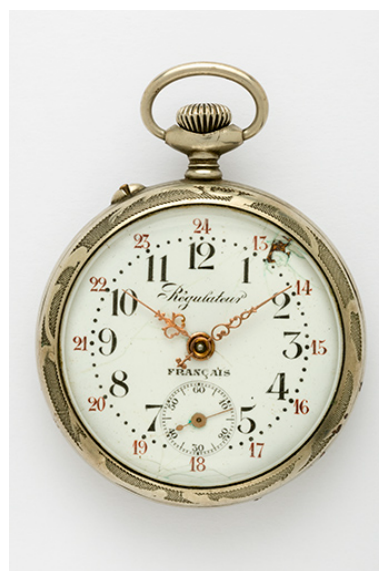
Exemple de montre donnant l'heure sur 24 h : montre de gousset mécanique de la marque Régulateur français (société Victor Anguenot et Cie). Phot. Sonia Dourlot IVR43_20162500685NUC4A
