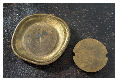
Ebauche obtenue par frappe à chaud (verso). Phot. Sonia Dourlot
