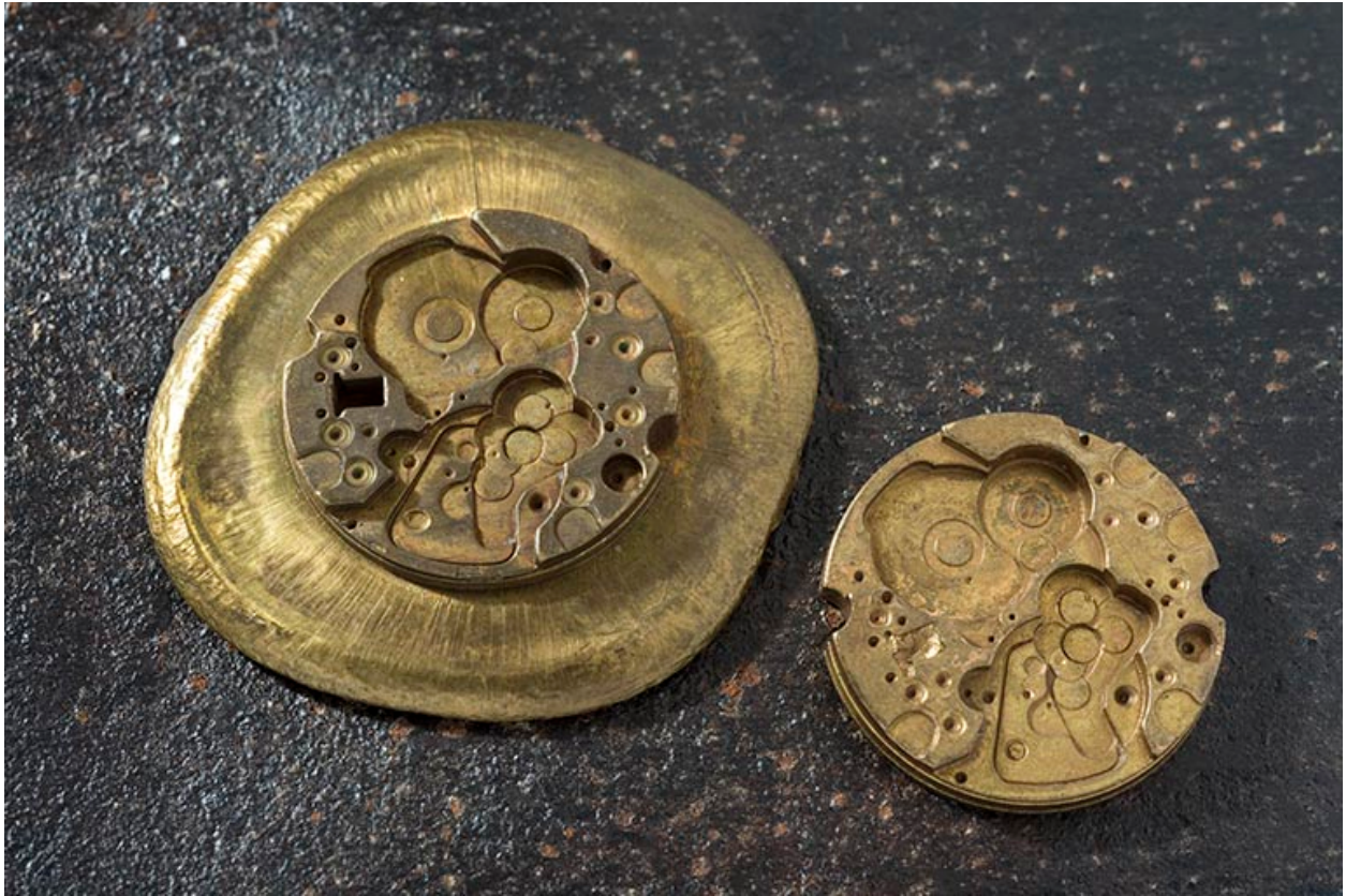
Ebauche obtenue par frappe à chaud (recto). Diamètre : 29,7 mm, épaisseur : 4,3 mm.
