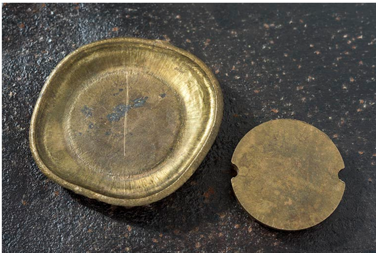
Ebauche obtenue par frappe à chaud (verso).
