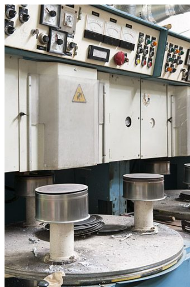
Poste de brasage par induction (pose du fond). Phot. Jérôme Mongreville IVR43_20112502316NUC4A
