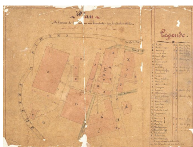
Plan de l'usine de la Casserie avec les conduites de gaz, les réverbères et les becs. Plan, calque collé, encre, lavis, échelle 1/500, s.d. [fin 19e siècle]. Phot. Jérôme Mongreville, Autr. IVR43_20122501185NUC4A
