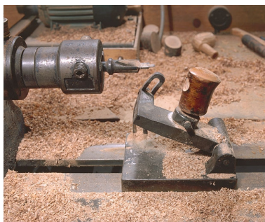
La cuillère et lui, faisant face, le fourneau à usiner sur son chariot mobile. Phot. Jérôme Mongreville IVR43_20022500567XA
