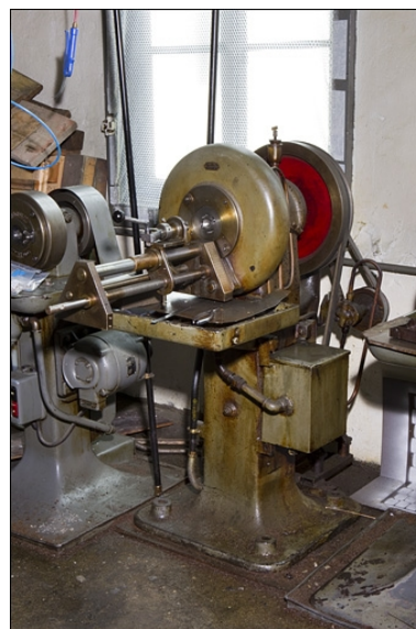
Usine Gouverneur-Audigier, Morez : machine à rétreindre Chanay et Maitrot. Phot. Yves Sancey IVR43_20103900310NUC2A
